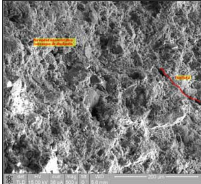
Figura 26.- Panorámica del Arreglo Cristalino, Núcleo 1. Nótese la presencia de la porosidad intercristalina y en fracturas con rasgos de disolución.
