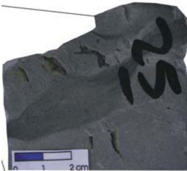
Figura 13.- Fracturas Diagenéticas con Disolución, Núcleo 3.
