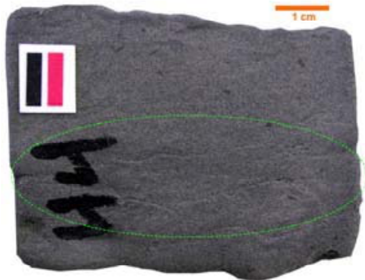
Figura 24.- Fracturas Tectónicas Abiertas Subparalelas a la Estratificación.
