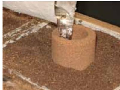
**Figura 3.9** Toma de muestra y vaciado en la copa para análisis térmico.
