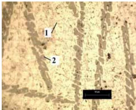
**Figura 2.30. Microestructura d una aleación maestra Al-10Sr. (1) Fase eutéctica(Al-Al<sub>4</sub>Sr) y (2) Placas grandes del intermetálico Al<sub>4</sub>Sr.**
