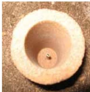
**Figura 3.3** Copa terminada con termopar al centro.
