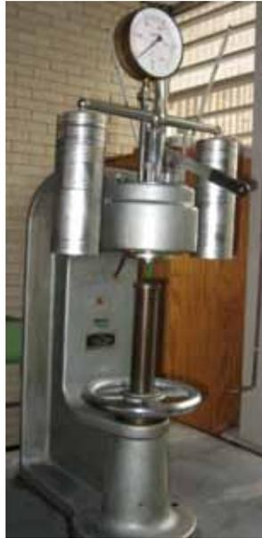
**Figura 3.11 Maquina para ensayo de dureza.**
