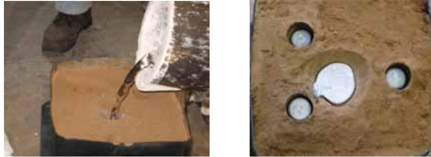
**Figura 3.10 Vaciado en el molde para fabricación de barras.**
