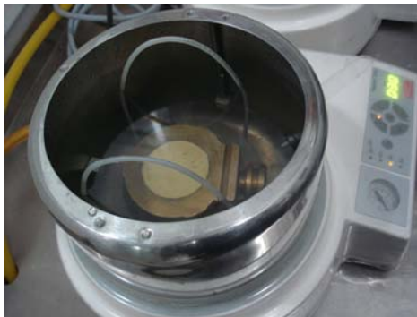
Fig. 29. Polimerización en Palamat practic.
