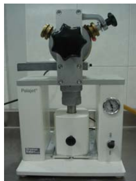
Fig. 28. Cilindro colocado en el sistema de inyección Palajet.
