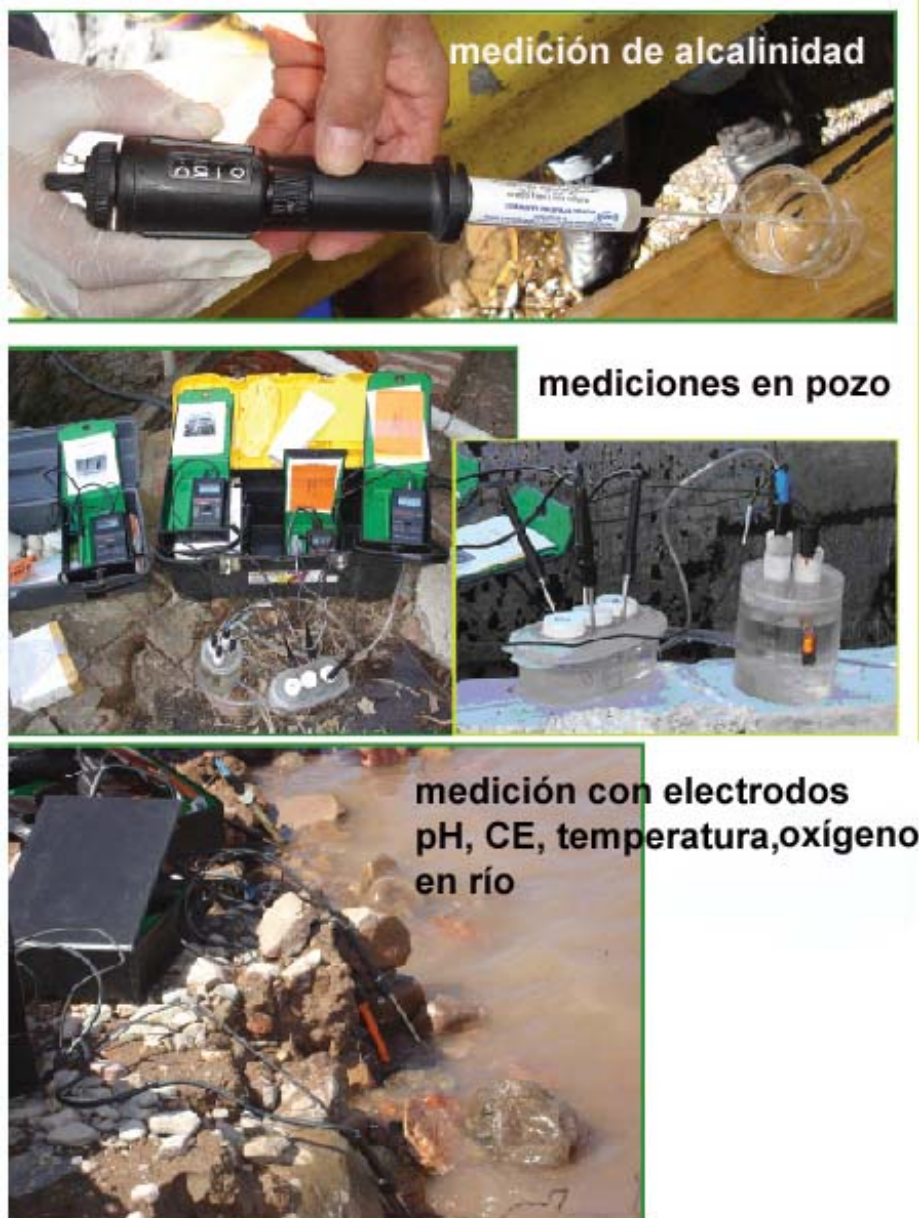
Figura 3.5. Equipos para medir pH, CE, temperatura, Eh, y alcalinidad, en campo.
