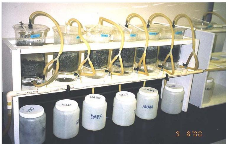
**Foto 1.2 Dispositivo de celdas húmedas.**
