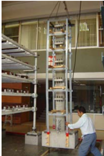
Figura 4.7 Traslado del muro hacia la MV
