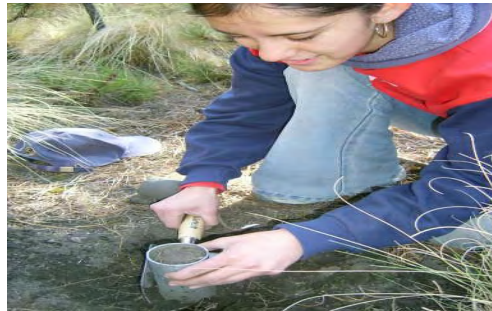
Figura 9. Que muestra la introducción del cilindro en el suelo, para determinar el contenido de humedad.
