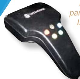
sión la posición y orientación de las partes del cuerpo, en relación con el modelo visualizado. Se tienen dos sensores uno para el rastreo del movimiento de la cabeza y otro que rastrea la posición y movimientos de un mouse tridimensional también llamado *wanda*. Además, se cuenta dentro de la sala con un guante inalámbrico *5DT Data Glove*, con dos sensores por dedo, para medir tanto la flexión como la abducción entre los dedos.
