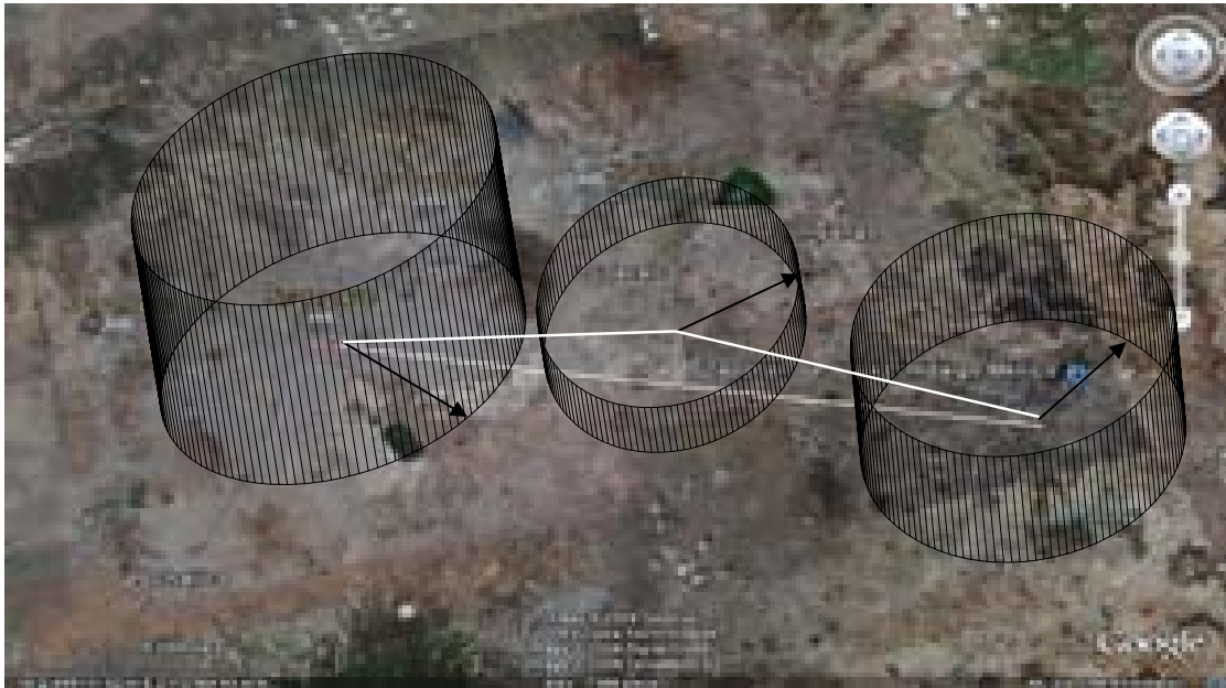
Figura 4.16. Espacios aéreos terminales de aproximación de 10 MN para el AICM, base aérea militar de Sta. Lucía y del nuevo aeropuerto de carga Tizayuca, Hgo.
