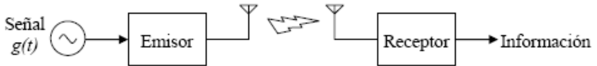
Fig. 3.10 Sistema de comunicaciones RF
