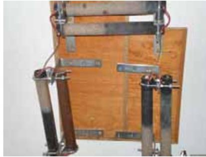
**Fig. 44 Resistencia de disipación para el frenado regenerativo**
