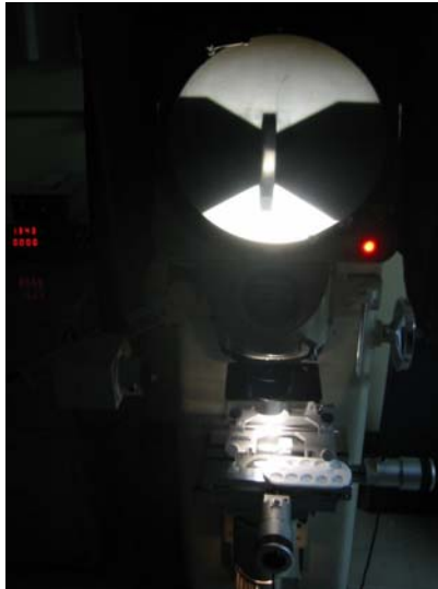
Figura 29. Determinación del ancho y diámetro de un monolito de \text{SiO}_2 , mediante un proyector de perfiles con resolución de un micrómetro.
