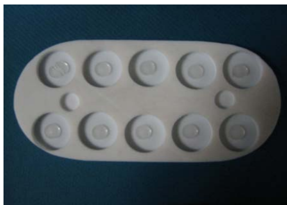
Figura 28. Obtención de monolitos de SiO 2 de SGNC.
