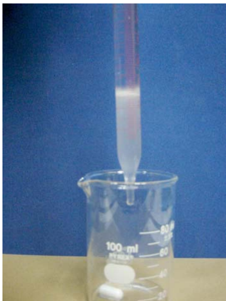
Figura 3A. Emulsión de TEOS/H 2 O al final del proceso de sonicación.
