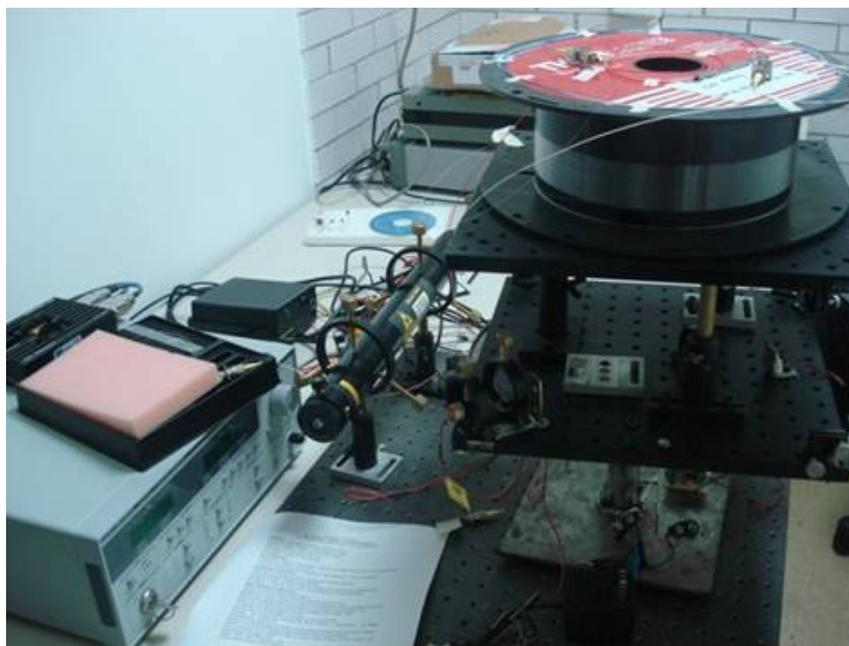
*Fig. 4.4 Fotografía del interferómetro de Sagnac en fibra óptica*
