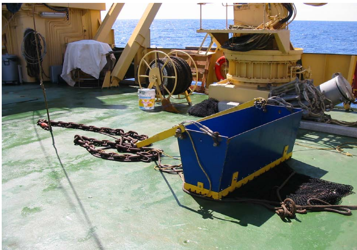
Figura 80. Draga de arrastre para rocas usada durante el crucero MARTIC04.
