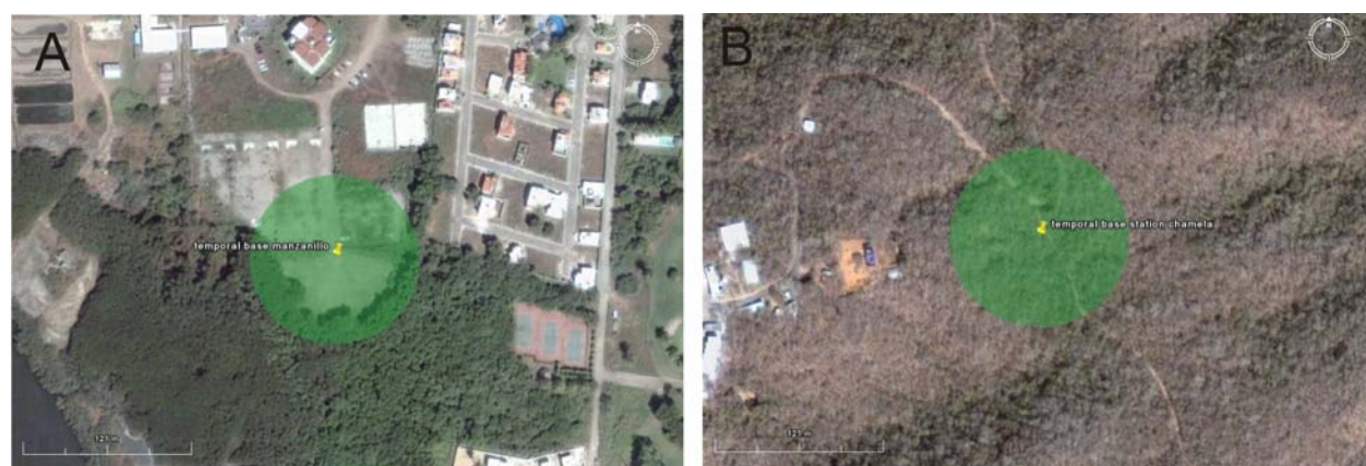
Figura 21. Mapas esquemáticos de las áreas de seguridad respecto a perturbaciones magnéticas para las estaciones base. A). Base magnética temporal en Manzanillo, B): Base magnética temporal en Chamela.
