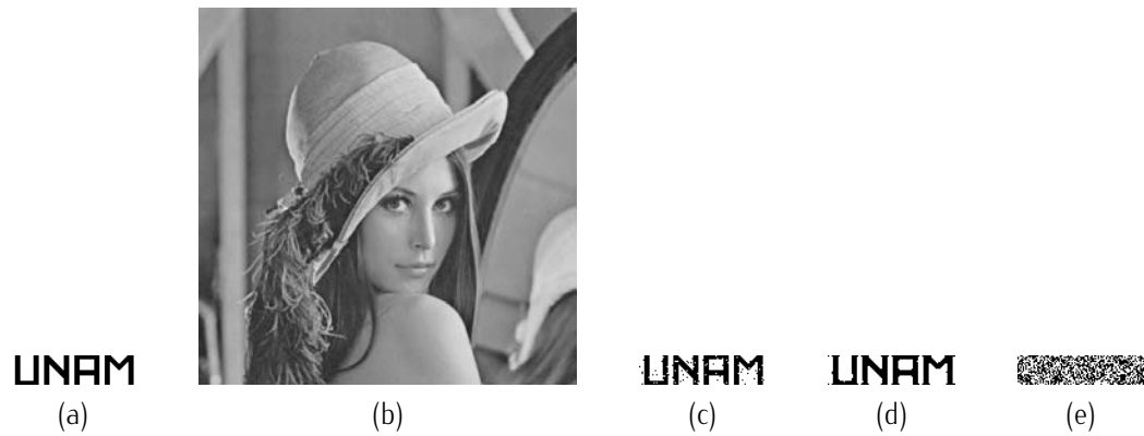
Figura 4.12: Gráfico de los logos original y recuperado de la imagen marcada utilizando el tercer método. (a) muestra el logo original. (b) muestra la imagen marcada. (c) muestra el logo recuperado. (d) muestra el logo recuperado después de un filtro de mediana y (e) muestra un logo recuperado sin una llave autorizada.
