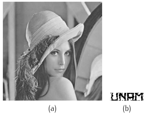
Figura 4.22: (a) Lena marcada con porcentaje de compresión de 20%. (b) Logo recuperado de la imagen con porcentaje de compresión de 20% utilizando método 3.
