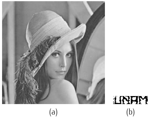
Figura 4.24: (a) Lena marcada con porcentaje de compresión de 20%. (b) Logo recuperado de la imagen con porcentaje de compresión de 20% utilizando método 4.
