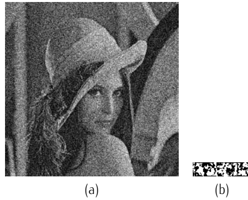
Figura 4.33: (a) Lena marcada con porcentaje de ruido del 10%. (b) Logo recuperado de la imagen con porcentaje de ruido del 10% utilizando método 4.
