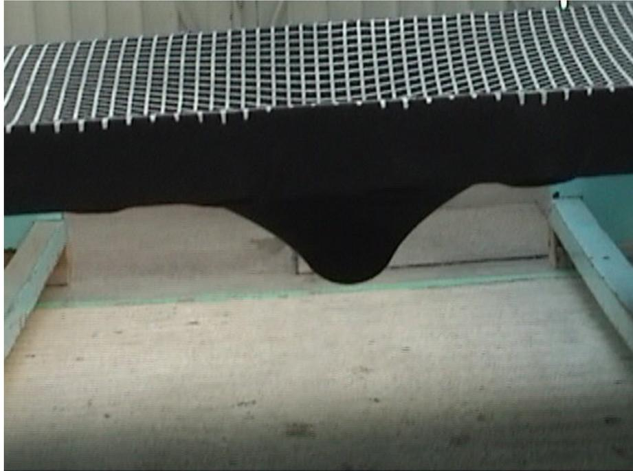
Fig. 3.24 Vista de perfil de la deformación causada por la pelota metálica.
