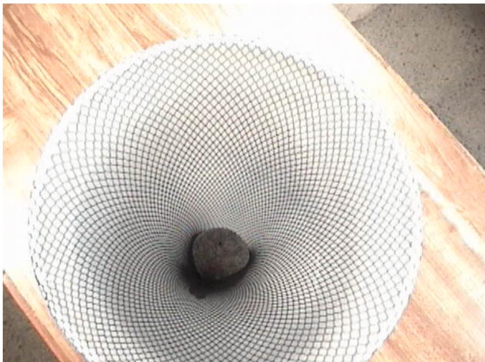
**Fig. 3.31 Bote de 19 L de pintura con una media de licra y una pelota metálica.**
