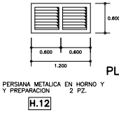
H.12 PERSIANA METALICA EN HORNO Y PREPARACION 2 PZ.
