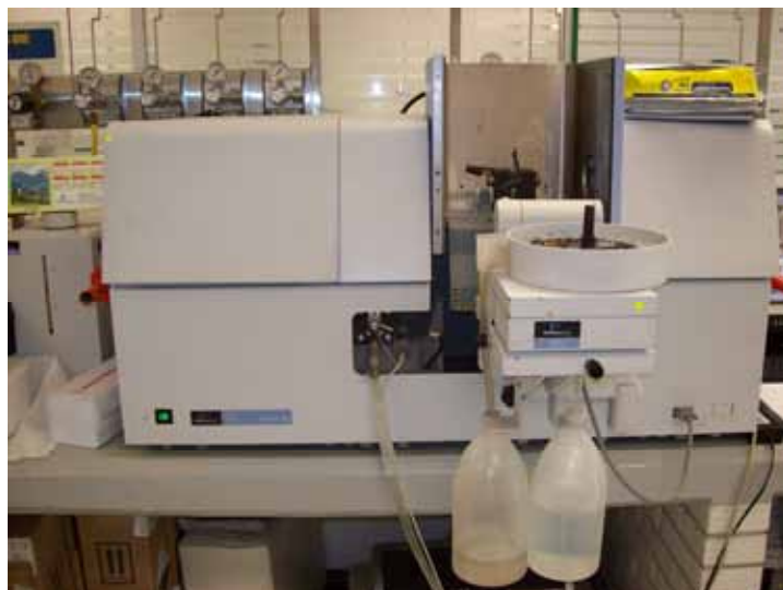
Figura 5.7 Espectrofotómetro (Perkin-Elmer AAnalyst 700) con aditamento de horno de grafito.
