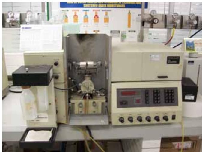
Figura 5.6 Espectrofotómetro (Perkin-Elmer 2380) con aditamento de generación de hidruros.
