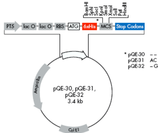
Figura 10. Mapa del vector de sobreexpresión pQE-30, que muestra de entre varias características los sitios de restricción (MCS), el sitio que codifica para la etiqueta de histidinas (6xHis) y el sitio donde se encuentra el gen de resistencia a ampicilina (Ampicilin).
