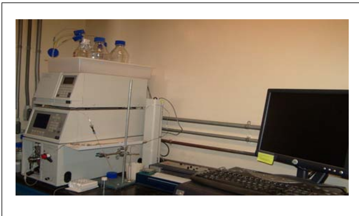
Figura 11. Equipo HPLC (Waters 2487) para la determinación del contenido de aminoácidos esenciales.
