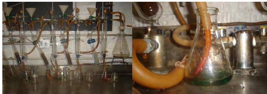
Figura 19. Destilación por arrastre de vapor, para obtener el N en forma de \text{NH}_4^+
