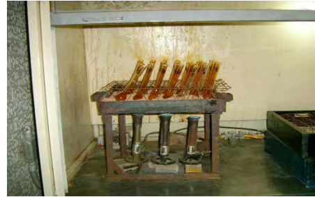
Figura 18. Digestión para determinación de N-total (transformación de N orgánico a inorgánico).
