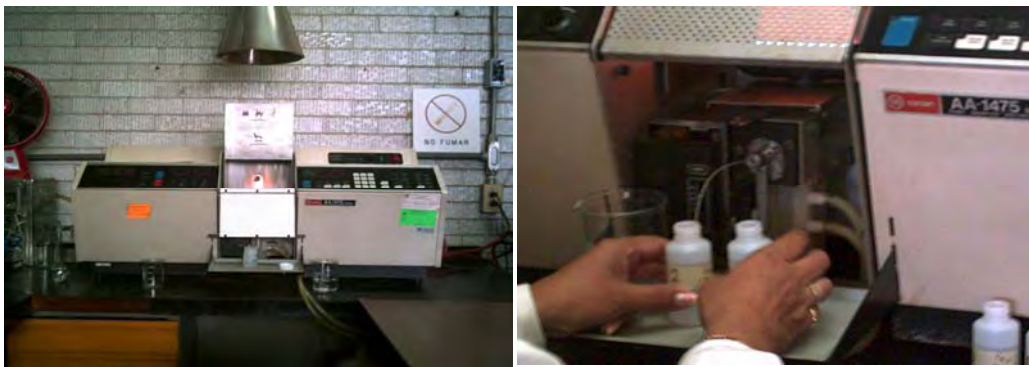
Figura 21. Lecturas de K + , Ca 2+ , y Mg 2+ en el espectrofotómetro de absorción atómica
