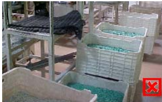
Fig. 8.- En la figura se puede ver como en el área de proceso junto a la materia prima se tiene enrollado un tapete antiderrapante. Este puede ser un foco de contaminación para el producto ya que toda la tierra del suelo cae sobre la materia prima.
