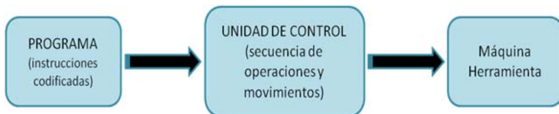
Figura 14. Componentes básicos de un CNC.
