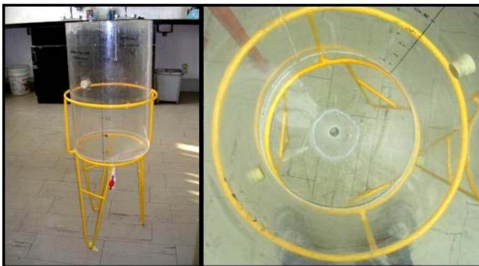
Figura 3.1. Diseño de lisímetro y estructura de sujeción.
