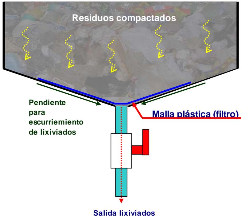
Figura 3.2. Sistema de drenaje de lixiviados
