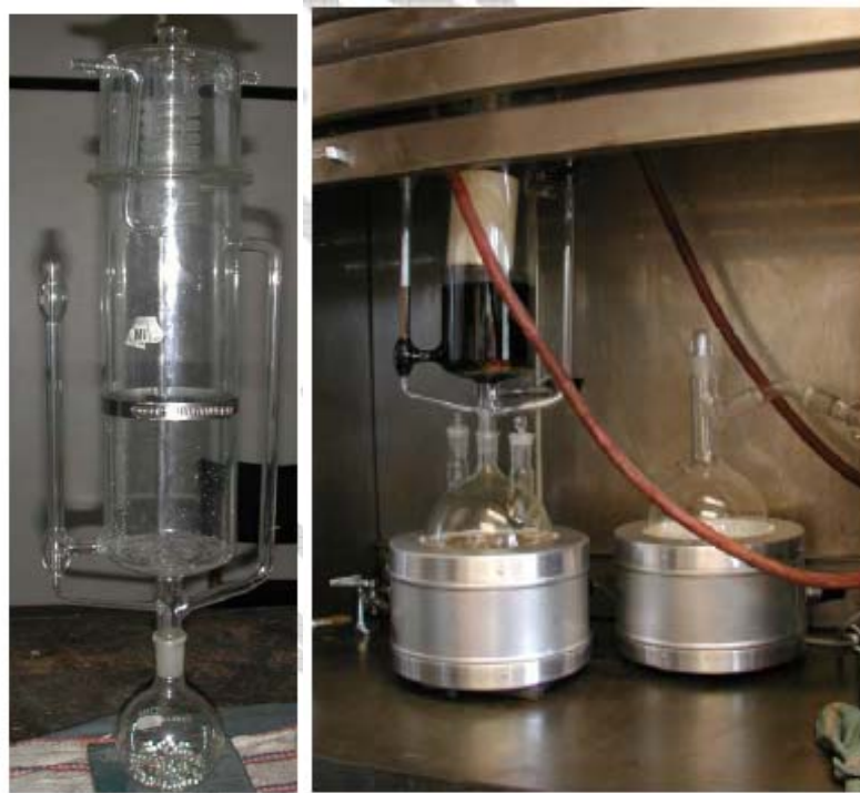
Fig. 4.1 Celda de destilación para limpiar núcleos de diámetro completo. Izquierda, vista de la celda completa. Derecha, celda dentro de campana limpiando un núcleo.
