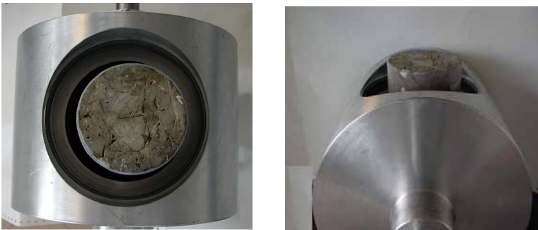
Fig. 4.4. Núcleo dentro de la celda de aluminio que permite la toma de imágenes con el tomógrafo.
