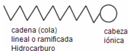
Fig. 2.2 Esquema de una molécula de surfactante.
