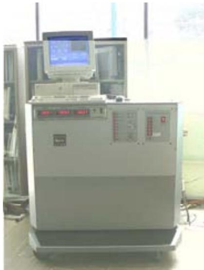
Fig. 4.1 Consola de control del banco de motores.
