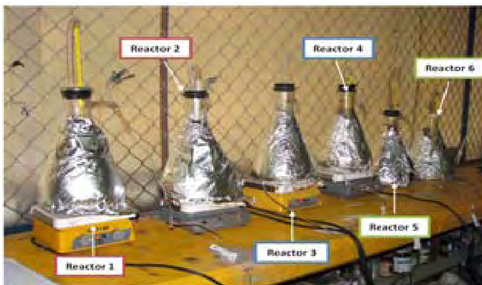
Figura 14. Instalación de los bioreactores. Con rotulo rojo los reactores con temperatura de activación inicial de 55°C; en azul aquellos con temperatura de activación inicial de 35°C, y en verde, los conservados a temperatura ambiente.
