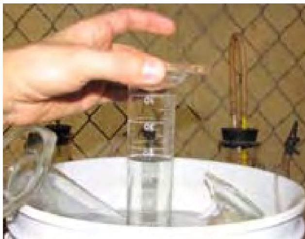
Figura 16. Medición del desplazamiento de agua debido a la producción de gas en el bioreactor.
