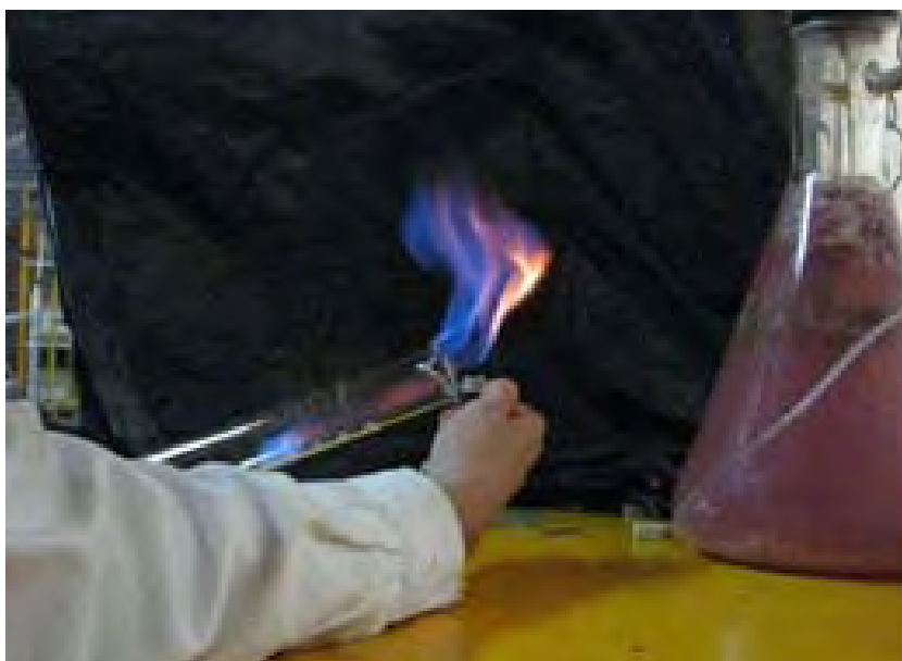
Figura 19. Combustión del gas producido en los bioreactores.
