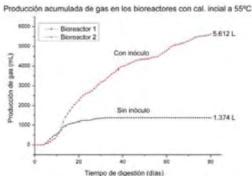
Figura 21. Gráfica de producción de gas acumulada en los reactores con calentamiento inicial a 55°C.
