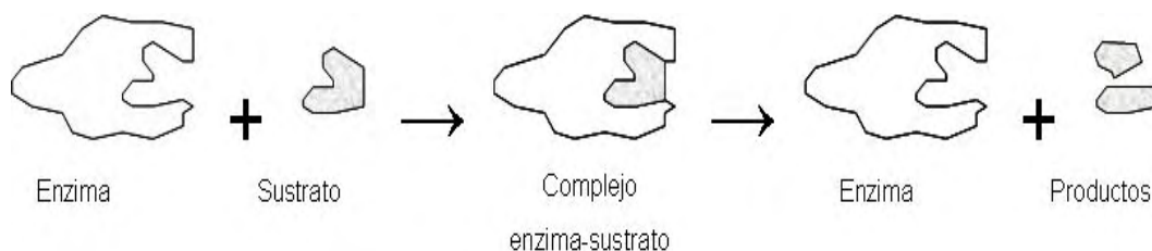
Figura 1.4.A. Representación esquemática de una reacción catalizada por enzima.
