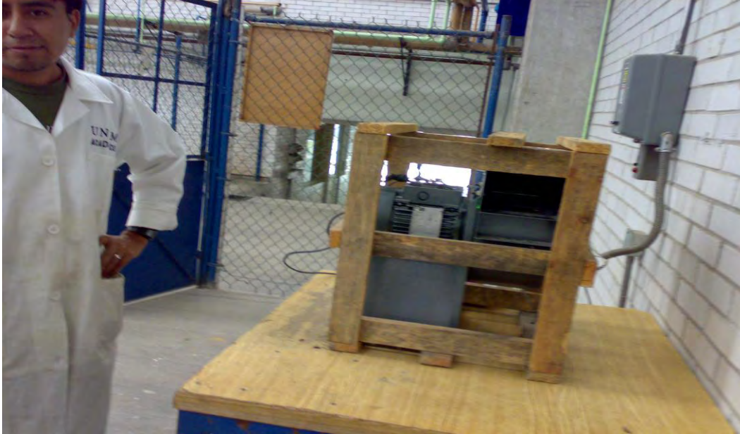
Ventilador Para El Túnel De Viento
