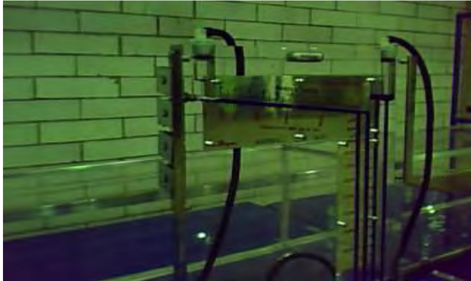
Manómetro inclinado conectado a la sonda pitot
