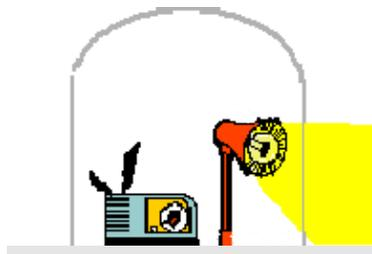
Como se sabe, se colocan una lámpara encendida y un radio de baterías encendido con un volumen alto, se coloca la campana y se sella herméticamente. A continuación se hace el vacío y se observa lo que ocurre. La discusión va en dirección de la propagación de la luz en el vacío y como es que el modelo corpuscular puede explicar dicho fenómeno.
