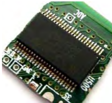
Figura 5.58. Circuito integrado seccionado para análisis mediante MEB cuyas terminales presentan corrosión.
