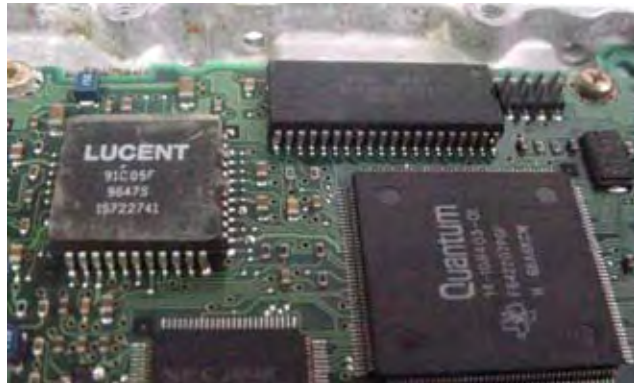
Figura 5.29. Tarjeta controladora de un disco duro con acumulación de condensado afectando todos los elementos que la componen.
