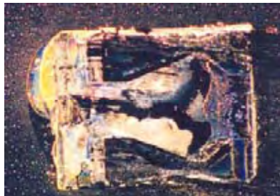
Figura 5.12. Marca de la adherencia de la cabeza de lectura/escritura al plato. [Sánchez, F., 2005]
