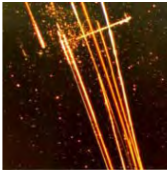
Figura 5.9. Rayones ocasionados por el contacto de la cabeza de lectura/escritura sobre la superficie del disco provocando a su vez desprendimiento de la capa de carbono (puntos luminosos).
