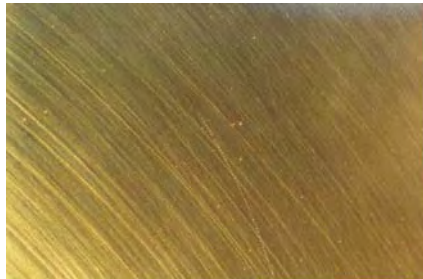
Figura 5.32. Marcas de vuelo del cabezal de lectura/escritura sobre la superficie del disco.
