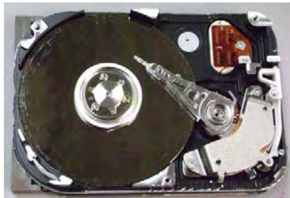
Figura 5.52. Superficie del plato con marcas realizadas por la cabeza de L/E.
