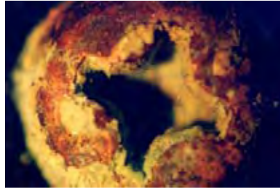
Figura 5.57. Formación de sales en tornillos de la carcasa.
