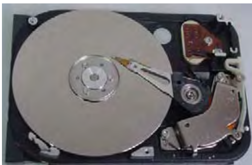
Figura 5.27. Aspecto interno de los discos después de ser sometidos al ensayo de simulación acelerada en donde no se aprecian evidencias de deterioro.
