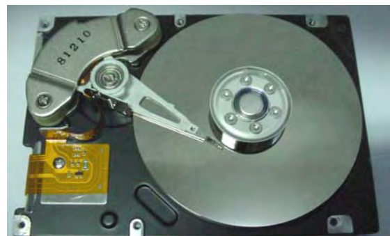
Figura 5.27. Aspecto interno de los discos después de ser sometidos al ensayo de simulación acelerada en donde no se aprecian evidencias de deterioro.
