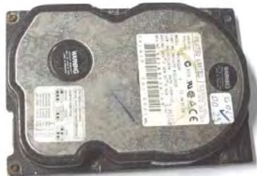
Figura 5.26. Apariencia de la carcasa de un disco duro. Nótese que dependiendo del material de la carcasa se tiene deterioro en mayor o menor medida sin dejar de existir el mismo en estos elementos.
