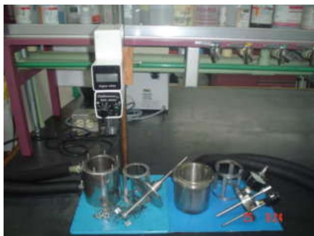
Figura 2.1. Tanques de acero inoxidable utilizados para la preparación de las pastas de almidón. En el tanque izquierdo (0.4 L de capacidad) se prepararon las pastas a 75, 80, 85, 90 y 92 °C. En el tanque derecho (0.5 L de capacidad) se prepararon las pastas a 120 °C.
