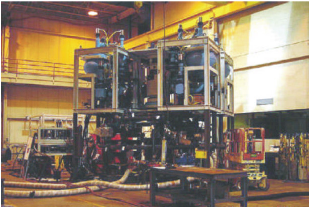
Figura 3.16 Sistema de bombeo submarino
