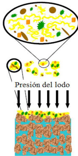
Figura 3.7. Polímeros ULIF y sólidos formando agregados en solución
