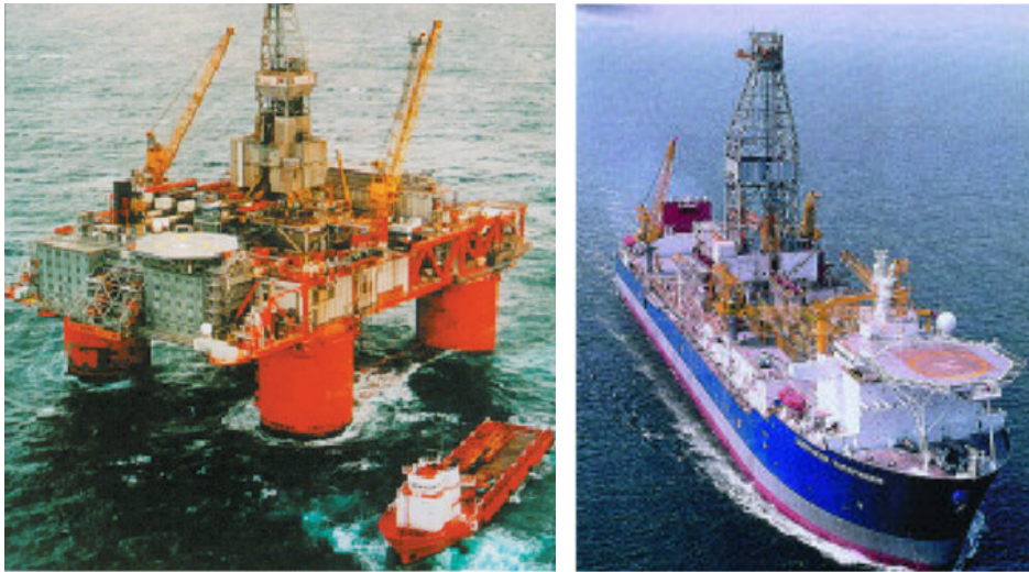
Figura 1.3 Plataforma de perforación semisumergible y barco perforador (Imágenes tomadas del libro “Un Siglo de la Perforación en México”)
