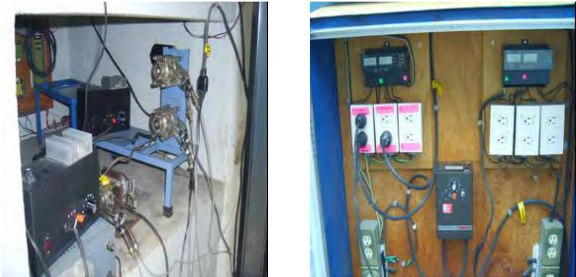
**Figura 3.2 Bombas peristálticas de muestreo (izquierda). Relojes programables (derecha)**
