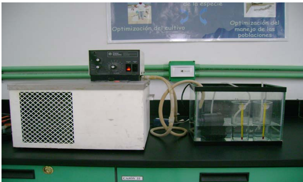
Figura 8. Montaje experimental para generar el descenso de temperatura. A la izquierda de la figura se observa el termostato Isotemp Refrigerated Circulator (Fisher Scientific) y a la derecha se observa el acuario con la bomba de aireación y las dos cámaras experimentales con termómetros y mangueras de aireación.
