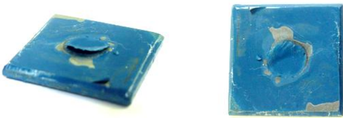
Figura 5.13 Probeta 1, se aprecia la degradación en gran parte del recubrimiento incluso en aquellas regiones que no estaban en contacto con el electrolito.
