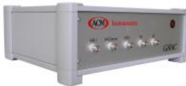
Figura.4.4 Potenciostato tipo GillAC de ACM Instruments.
