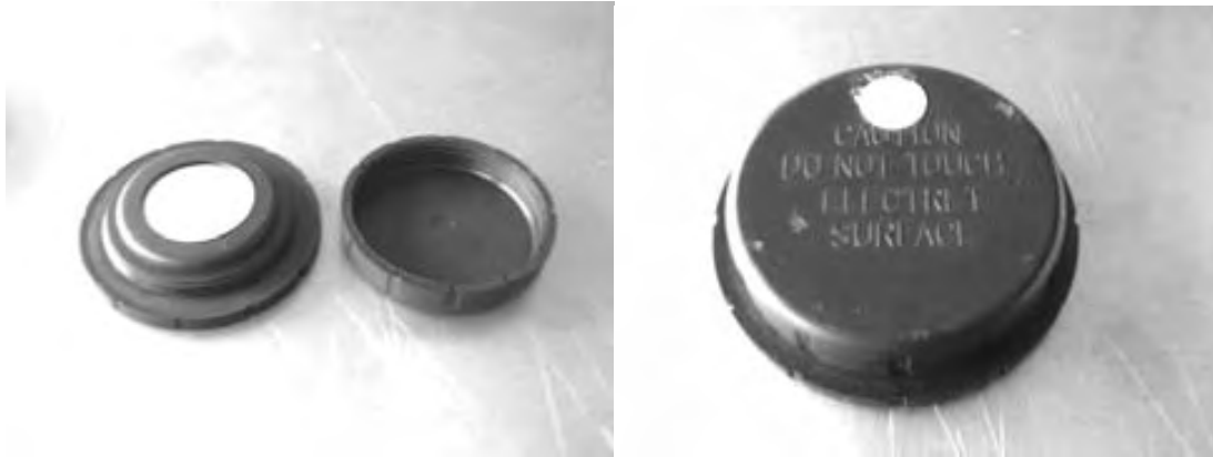
Figura 2.2.7. Electreto de Teflón cargado eléctricamente. Izquierda, destapado. Derecha con su cubierta taparosca
