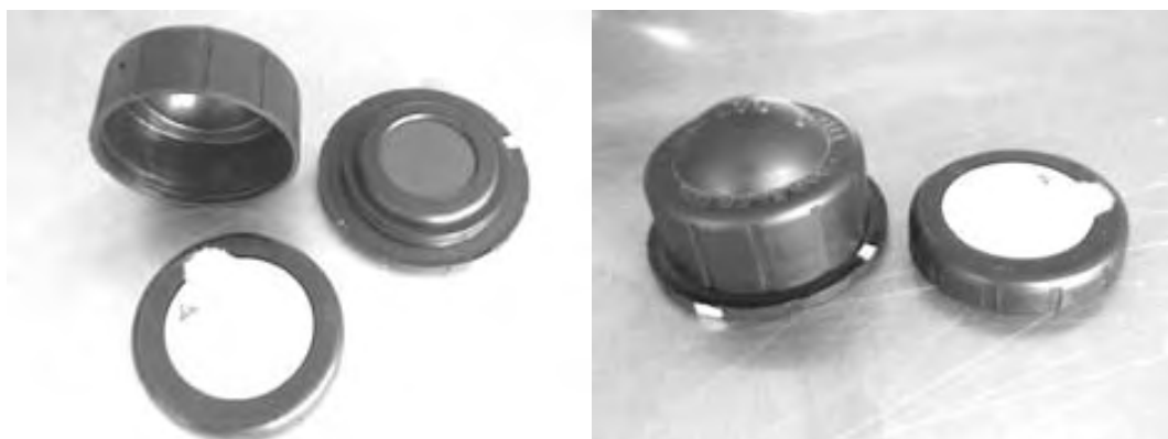
Figura 2.2.8. Cámara L de 50 mL con electreto de largo plazo (rojo)
