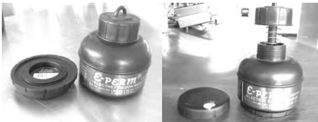
Figura 2.2.9. Cámara S de 210 mL con electreto de corto plazo (azul)
