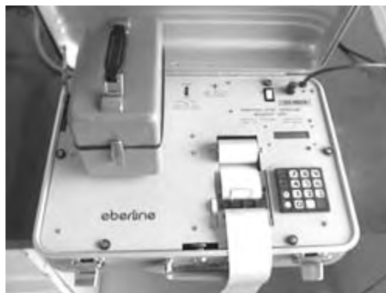
Figura 2.2.4. Recarga de la unidad muestreadora WLM-1A con la unidad lectora WLR-1A
