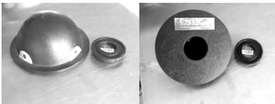
Figura 2.2.10 Cámara H de 960 mL con electreto de corto plazo (azul)
