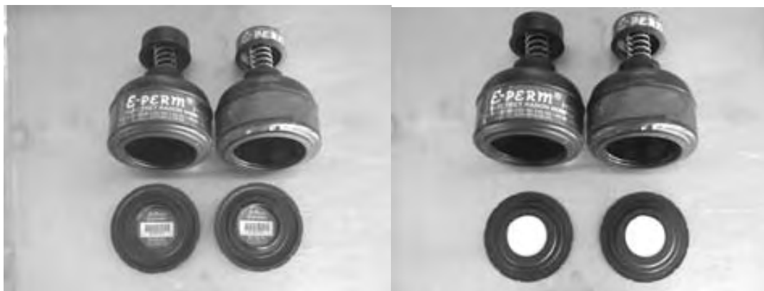
Figura 2.2.13. Cámaras de radón y torón con electretos de corto plazo (azules)
