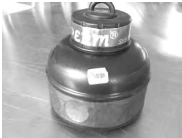
Figura 2.2.12. Cámara de torón 210 mL
