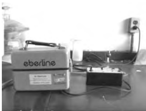
Figura 2.2.5. Recarga de la unidad muestreadora WLM-1A con el cargador de batería BC-WLM
