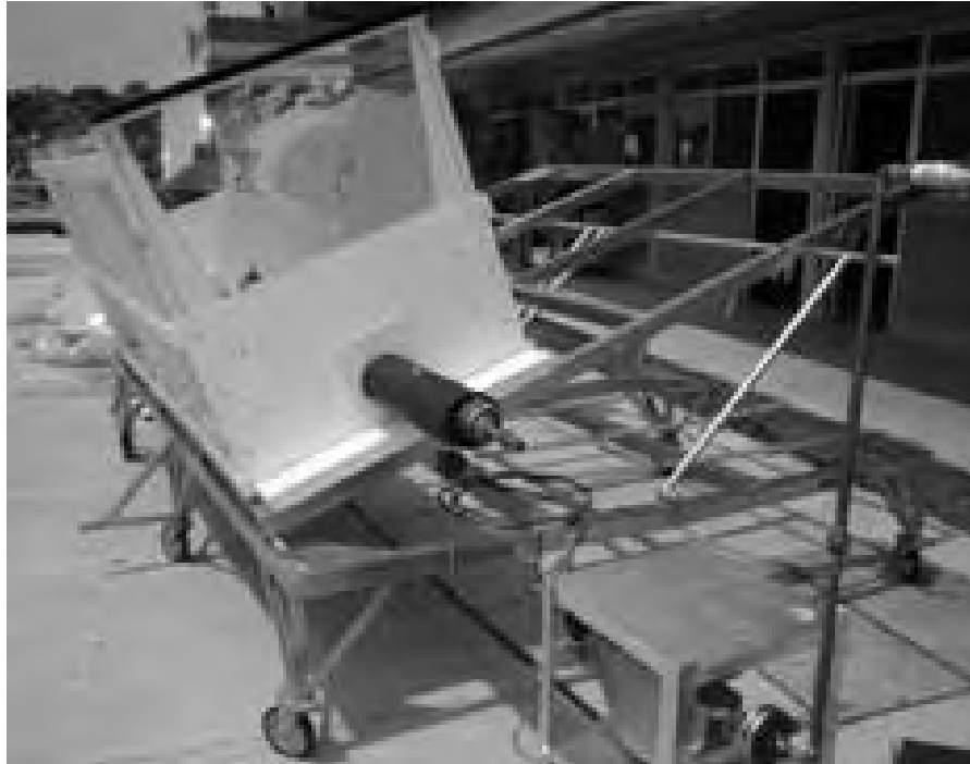
Figura 4.16. Prototipo del concentrador montado sobre la base de acero con cinco ángulos de inclinación ( 0^\circ , 10^\circ , 21^\circ , 30^\circ y 40^\circ )
