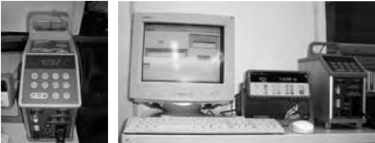
Figura 4.24. Calibrador de sensores de temperatura y sistema de calibración
