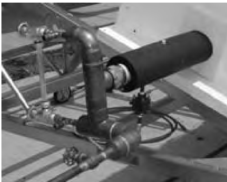
Figura 4.30. Conexión de salida del concentrador parabólico compuesto
