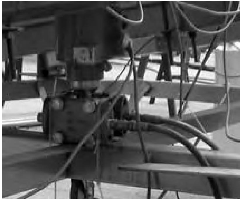
Figura 4.29. Transductor diferencial de presión montado en plataforma
