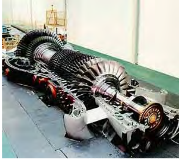
Figura 2.10 Turbina de Vapor.
