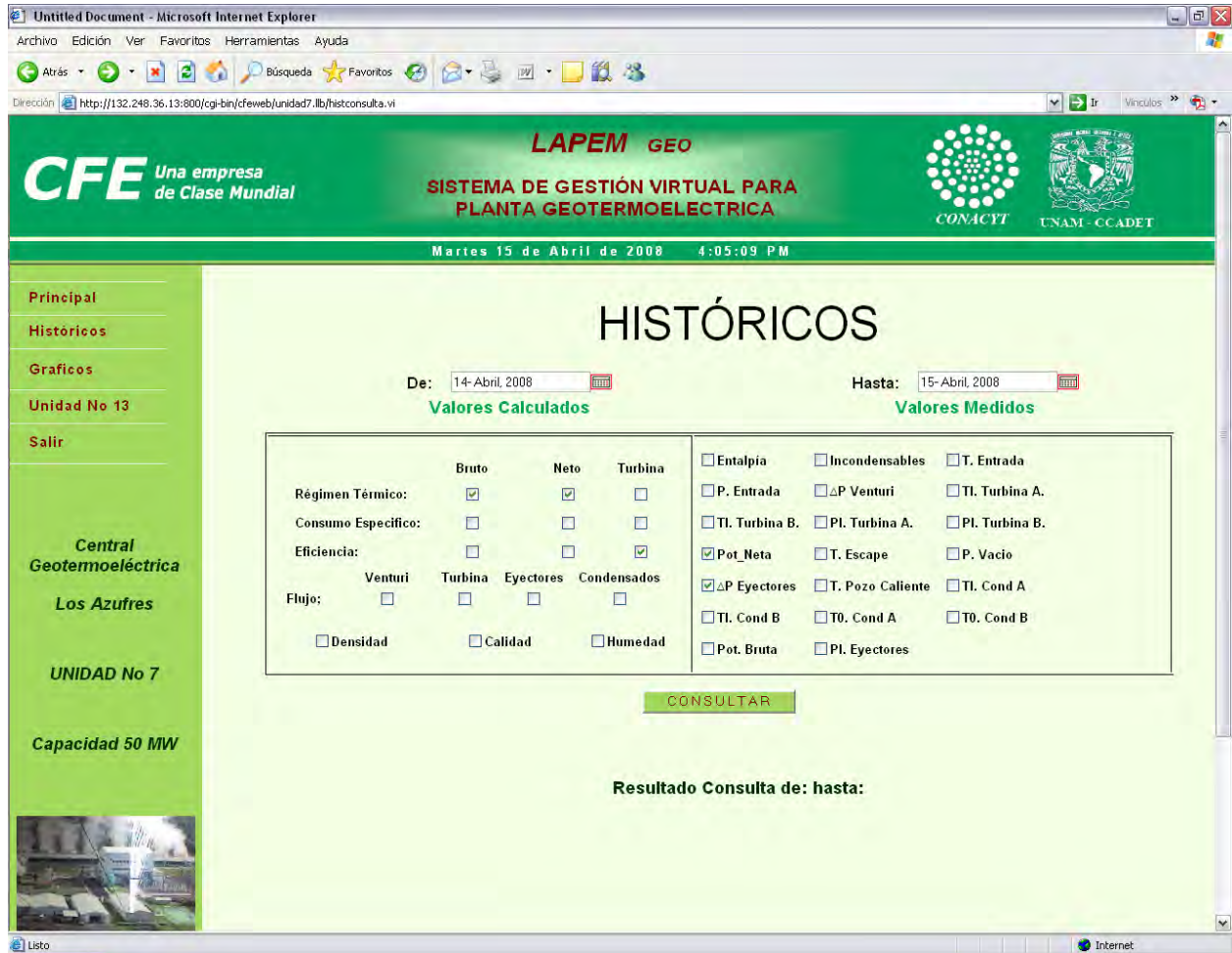
Figura 3.31 Página de consulta de históricos de los parámetros de operación de la planta.
