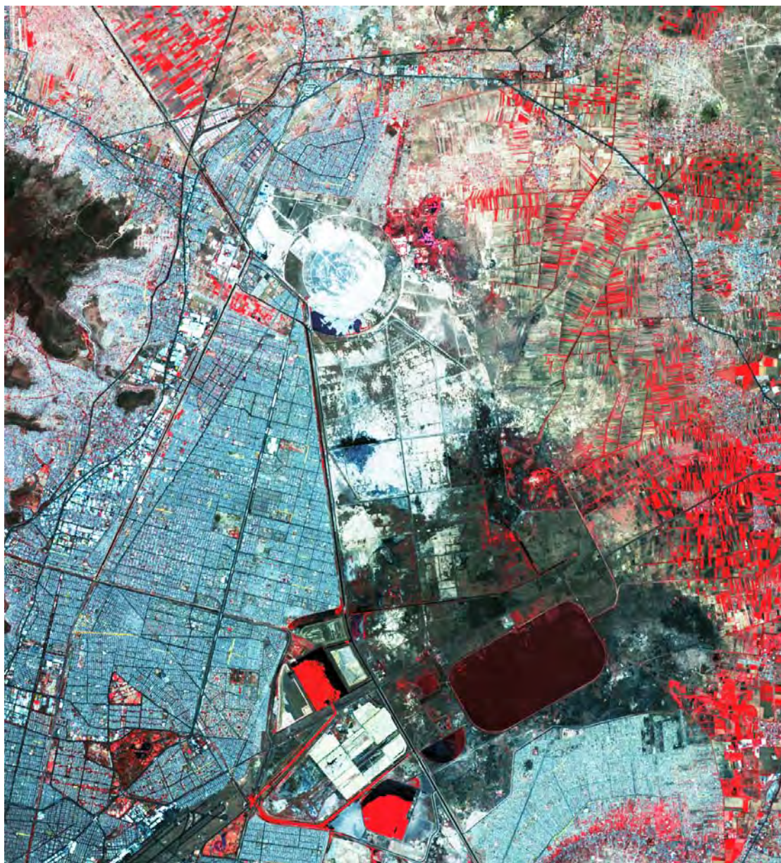
Figura 1.13: Composición en falso color de la zona de Texcoco (México), empleando las tres bandas del subsistema VNIR mediante el sensor TERRA/ASTER.
