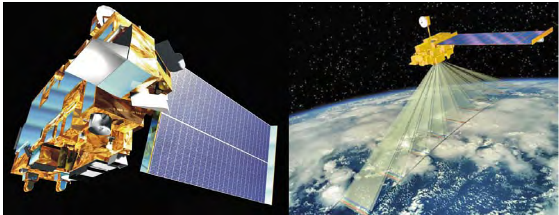
Figura 1.11: A la izquierda, se tiene un acercamiento de la plataforma EOS-TERRA (EOS-AM1). A la derecha se muestra la misma plataforma y las direcciones de observación de las nueve cámaras MISR. Adaptado de (University of California, 2008; Space Science, 2008).
