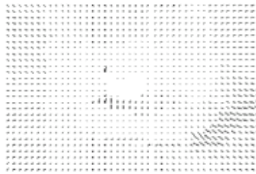
Figura 4.8. Campo de vectores de movimiento para la secuencia "table tennis". Tomada de [51].
