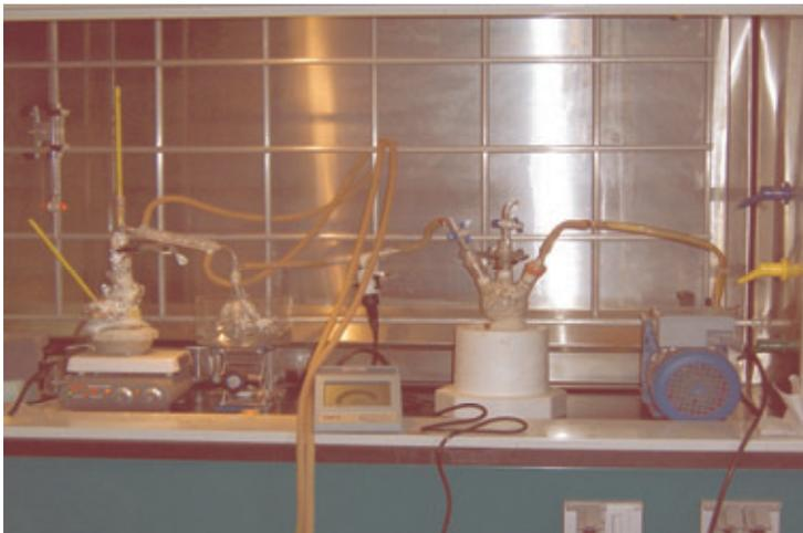
**Figura 2.2. Instalación para la destilación del monómero (3OT).**
