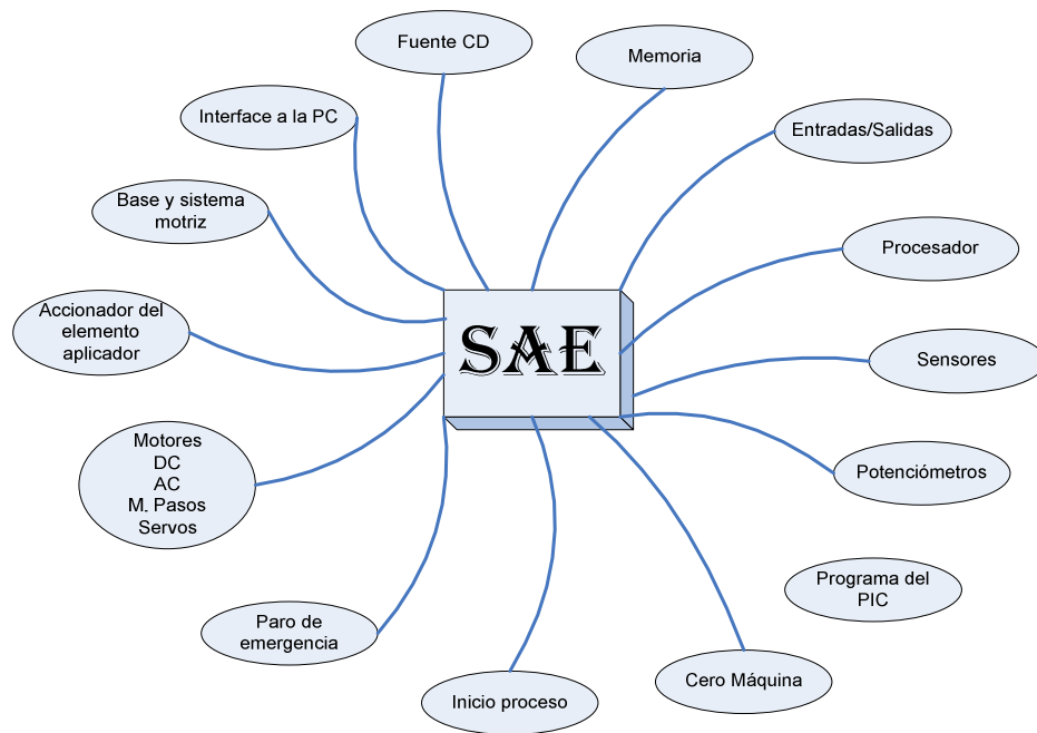
Diagrama II.1. Diseño conceptual del sistema aplicador de electrocatalizador.
