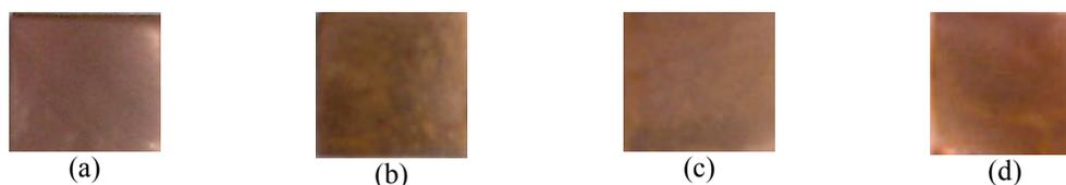
Figura 3.15. Fotografías de Cobre con cromatizado a diferentes tiempos de inmersión (a) 0s, (b) 10s, (c) 30s y (d) 60s. Antes de la exposición a una atmósfera de alta humedad.
