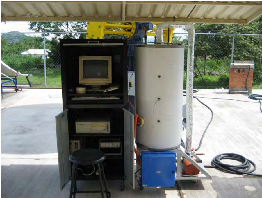
Figura 2.10 Sistema de suministro de agua precalentada y sistema de adquisición de datos.
