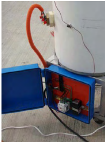
Figura 2.11. Sistema eléctrico y de control.
