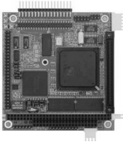
Figura 43. Módulo CPU Prometheus PC/104
