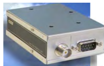
Figura 38. Conexión para antena y puerto serial
