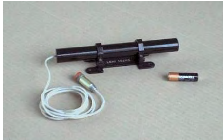
Figura 10. Vista del sensor magnético LEMI 106HS. (Imagen tomada del Proyecto Kompas-2, Rusia, 2005)
