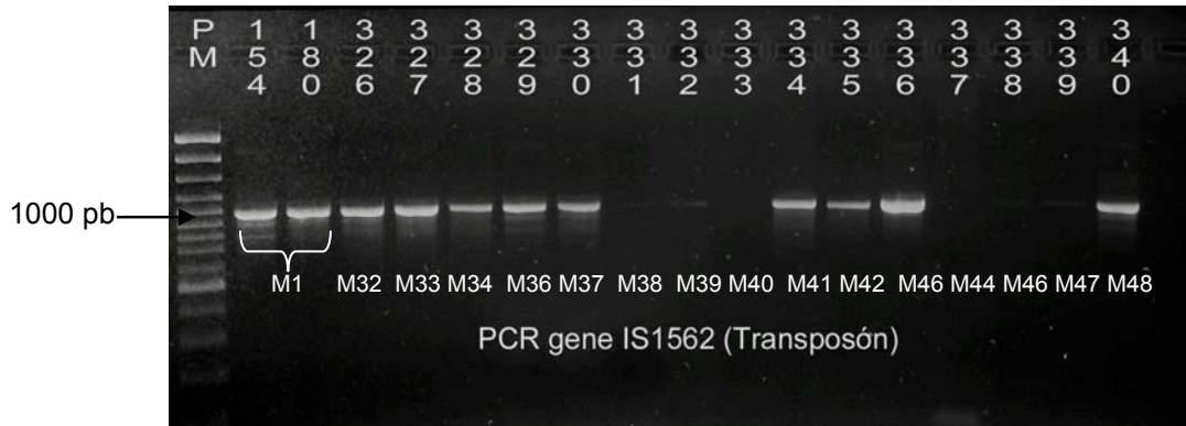
Figura 9. Amplificados de IS1562 en cepas de referencia. Electroforesis en 1.5 % de agarosa. En el primer carril se colocaron 4 \mu L de marcador de peso molecular (PM) de 100 pb (Fermentans®), mientras que en los carriles 2 a 17 se colocó el producto amplificado IS1562. En los carriles 2 y 3 se encuentran los controles positivos (154 y 180). El tipo M de las cepas se indica debajo del amplificado.
