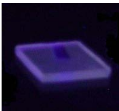
Fig. 4-1. Fotografía que muestra la emisión de fotoluminiscencia de nanopartículas de silicio embebidas en nitruro de silicio depositada sobre un sustrato de cuarzo.
