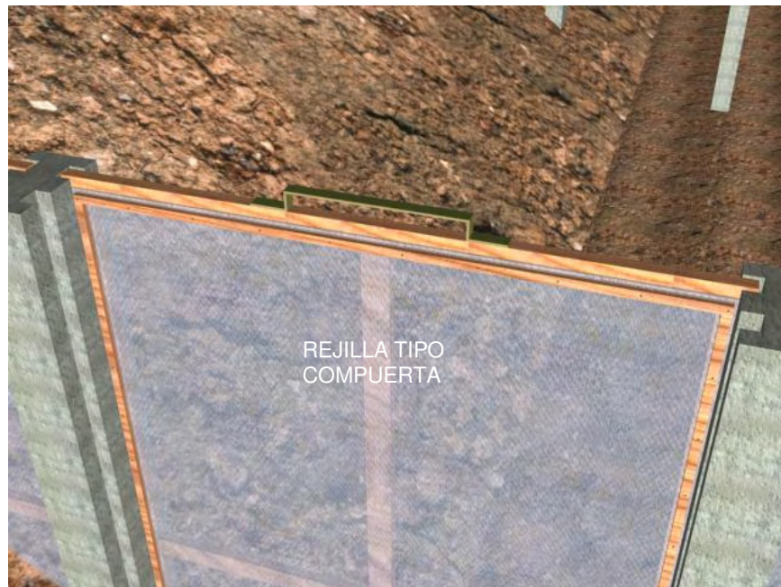
Dibujo 2.8. En este dibujo se observa el detalle de la rejilla tipo compuerta.
