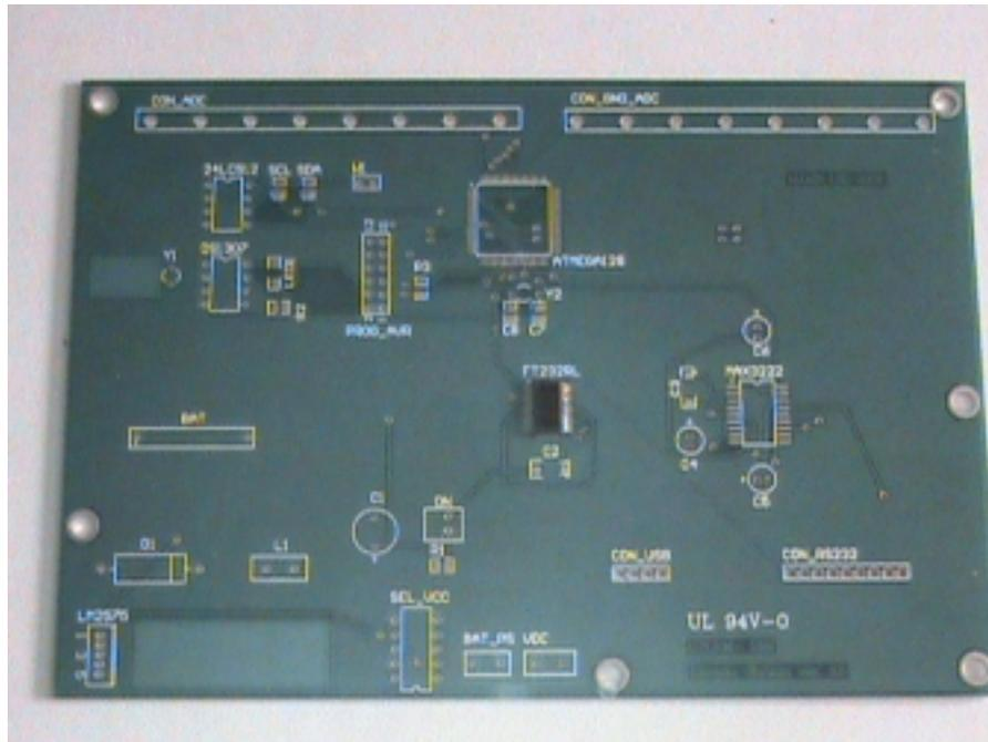
Figura 5.23. PCB de la estación remota versión 0.0.
