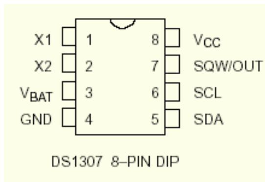
Figura 3.25. Diagrama del reloj en tiempo real DS1307.
