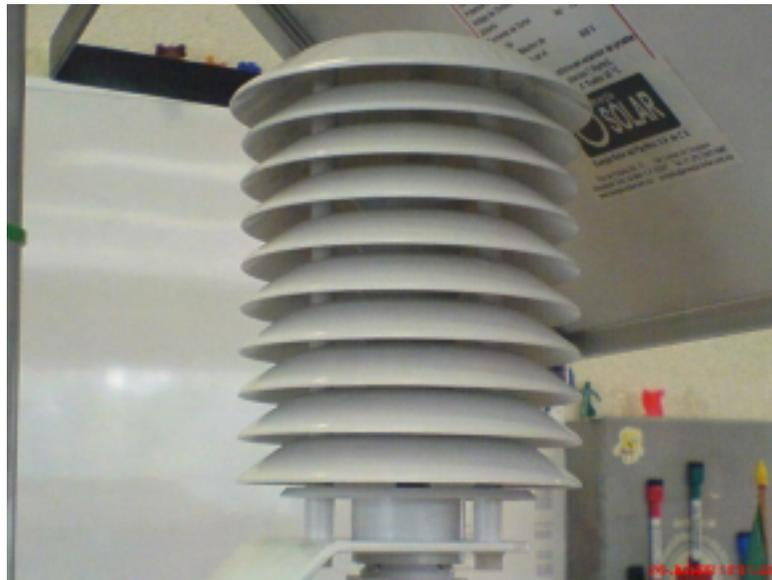
*Figura 3.39. Protector de radiación solar.*
