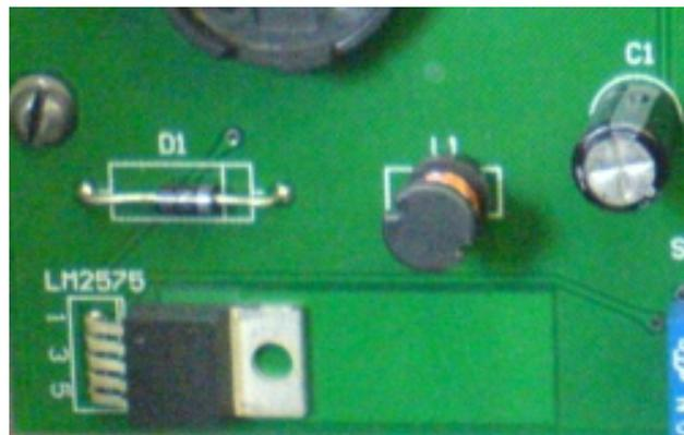
*Figura 3.19. Implementación del regulador conmutado LM2575.*
