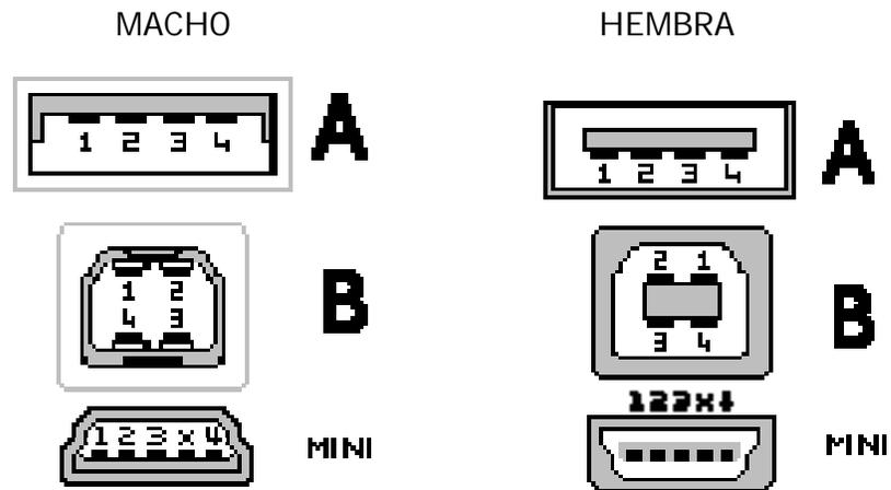
Figura 2.28. Formas de los conectores y terminales USB.
