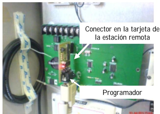
Figura 4.3. Conexión del programador a la estación remota.
