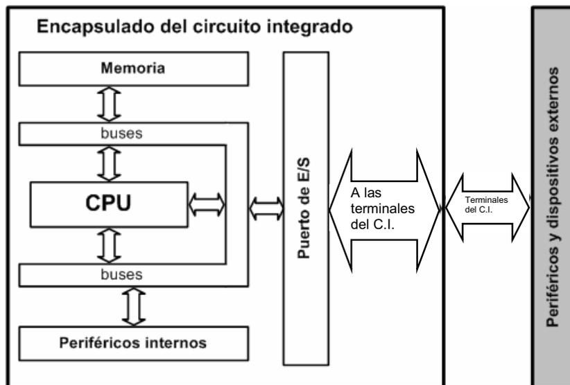
Figura 2.3. Arquitectura básica de un microcontrolador.
