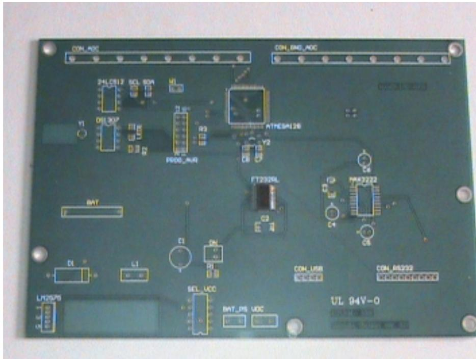
Figura 5.10. Circuito impreso de la estación remota versión 0.0 (vista superior).
