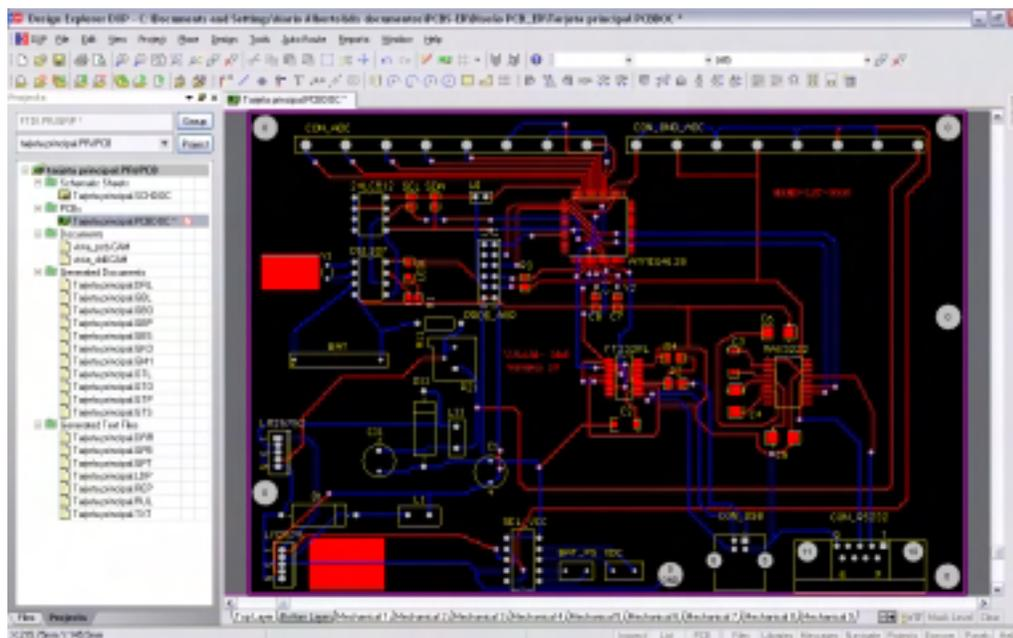
Figura 5.6. Circuito impreso generado por software.
