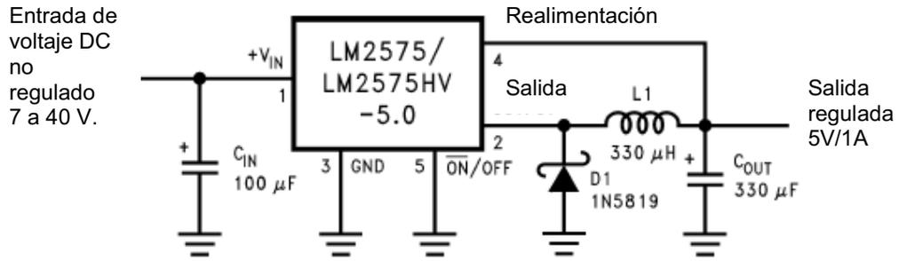
Figura 3.20. Configuración del regulador conmutado fijo 5V/1A.
