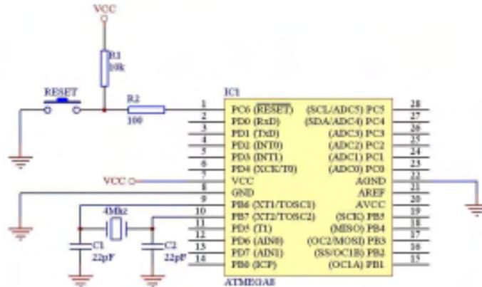
Figura 3.13. Circuito de interrupción externa por reset.
