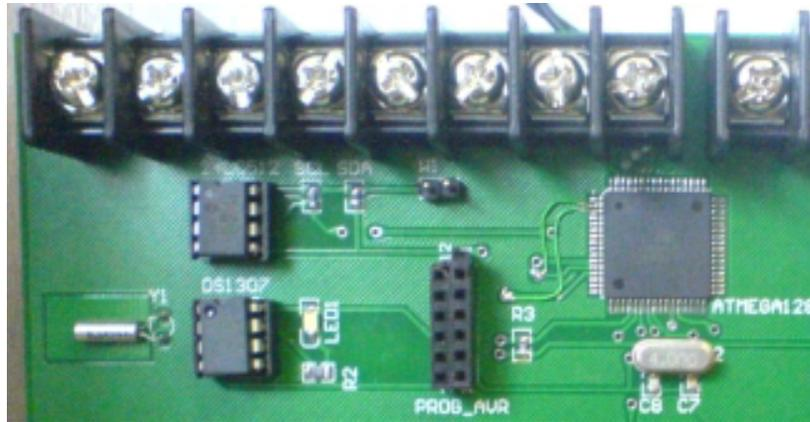
Figura 3.27. Implementación física del reloj DS1307 y la memoria 24LC512.
