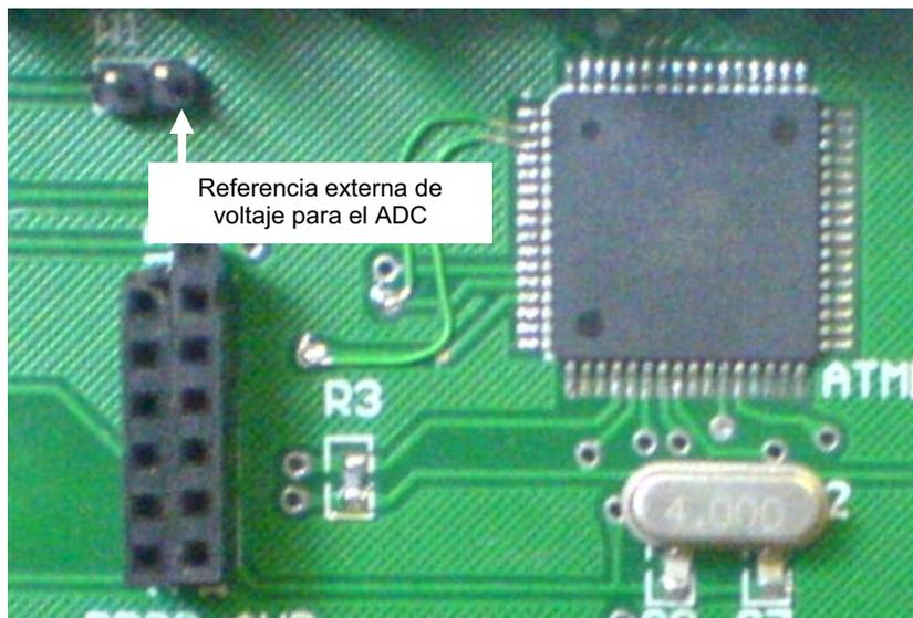
*Figura 3.30. Conector para referencia externa del ADC.*
