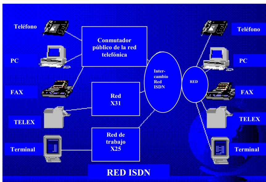
Figura 1.5. Elementos de una red ISDN.
