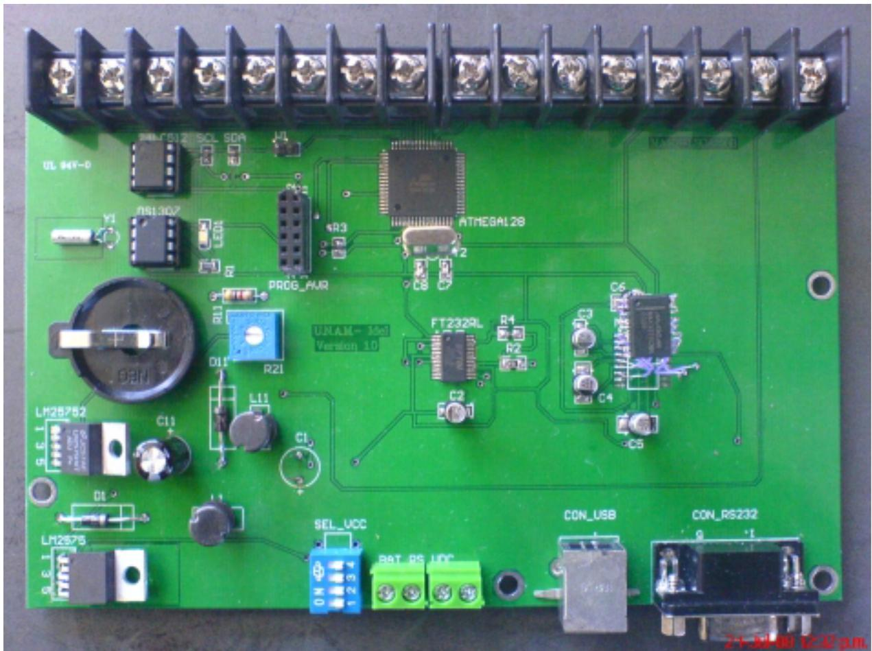
*Figura 5.24. Tarjeta de circuito impreso versión 1.0 armada.*
