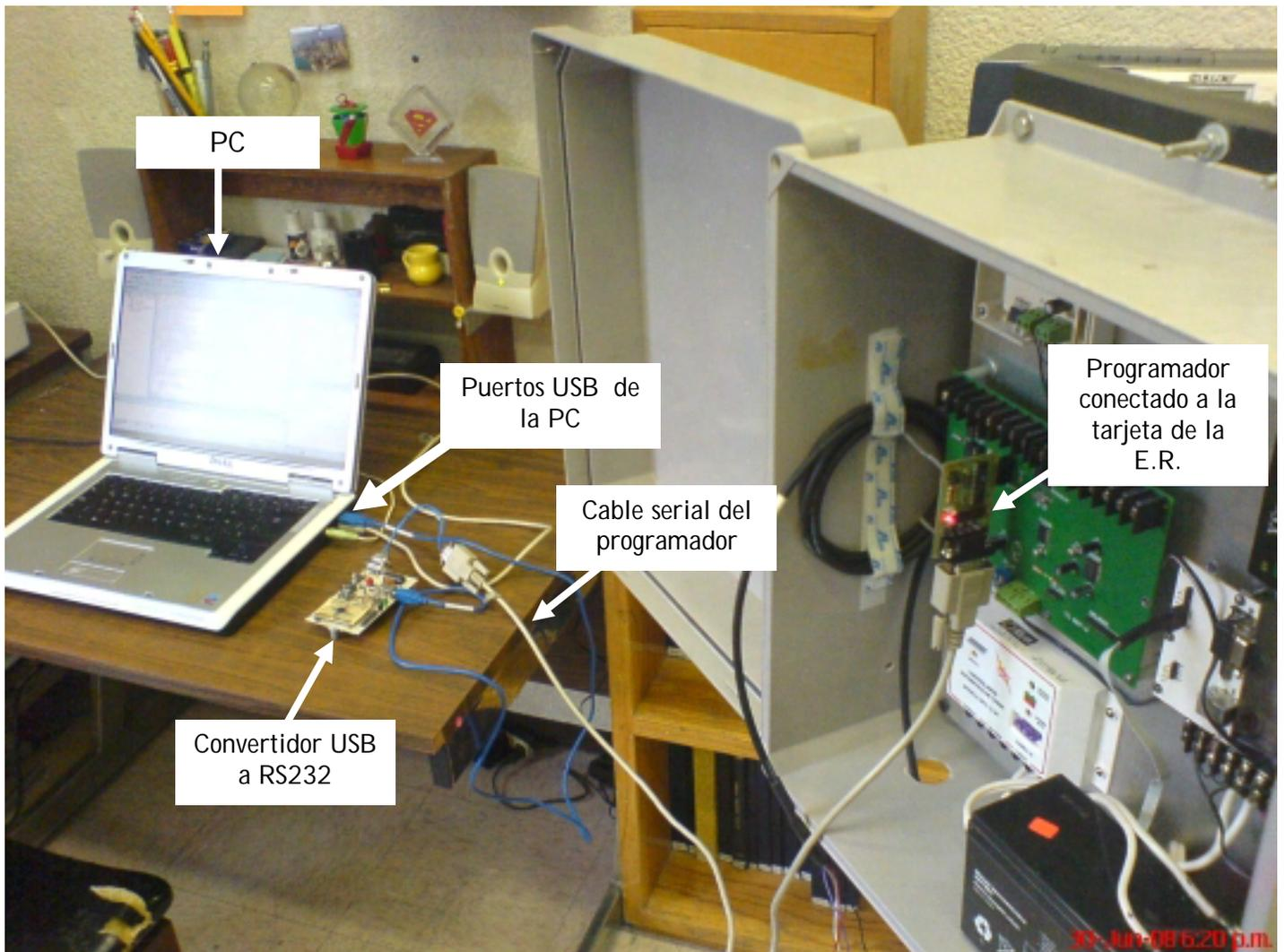
*Figura 4.4. Conexión de la PC con el programador AVR Titán EX.*
