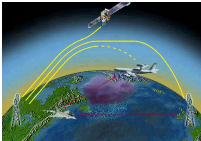
*Figura 1.3. Transmisión de señal vía satélite y mediante rebote ionosférico.*
