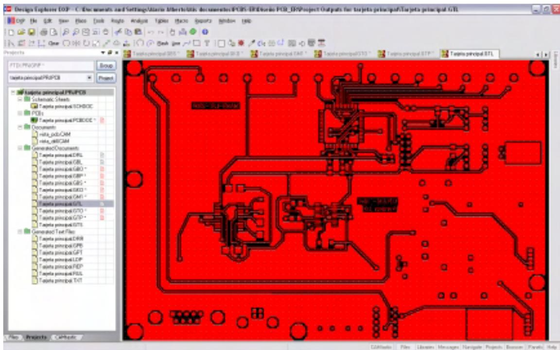
Figura 5.8. Archivo Gerber para la cara superior de la PCB.
