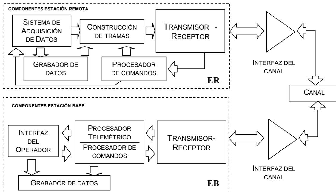
Figura 1.6. Un sistema generalizado de telemetría y comando.
