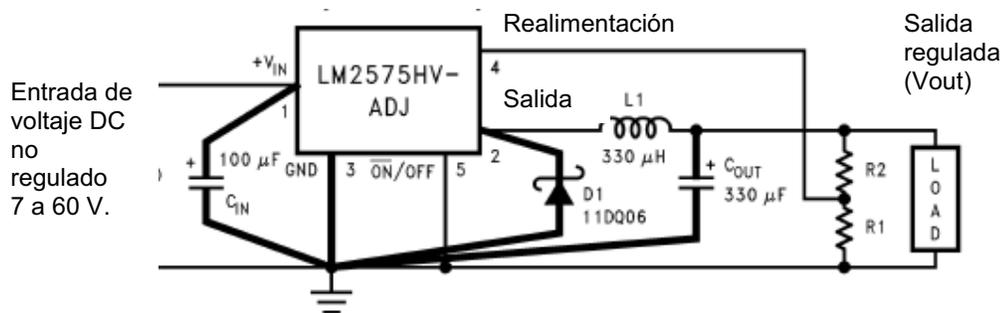
Figura 3.22. Configuración para el regulador conmutado variable.
