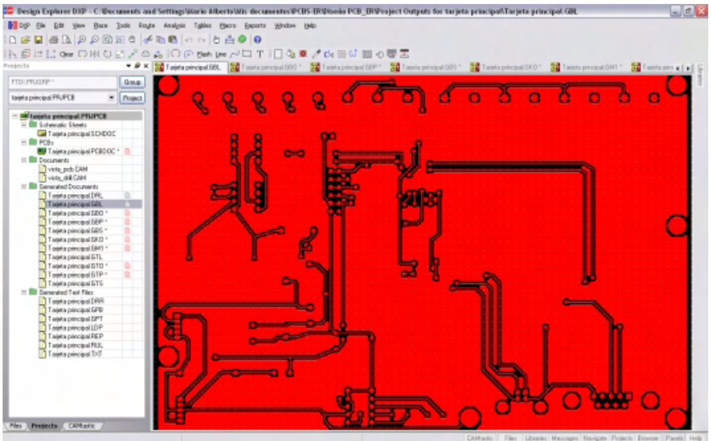
Figura 5.7. Archivo Gerber para la cara inferior de la PCB.
