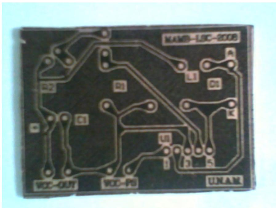
Figura 5.17. Circuito impreso de la fuente de 2.56 V.
