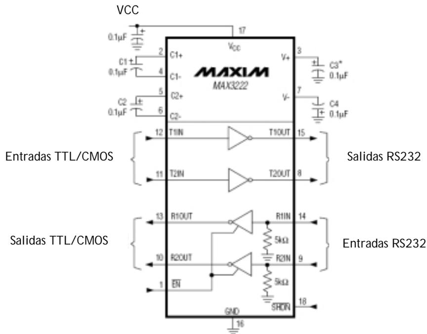
Figura 3.33. Aplicación típica del MAX3222.
