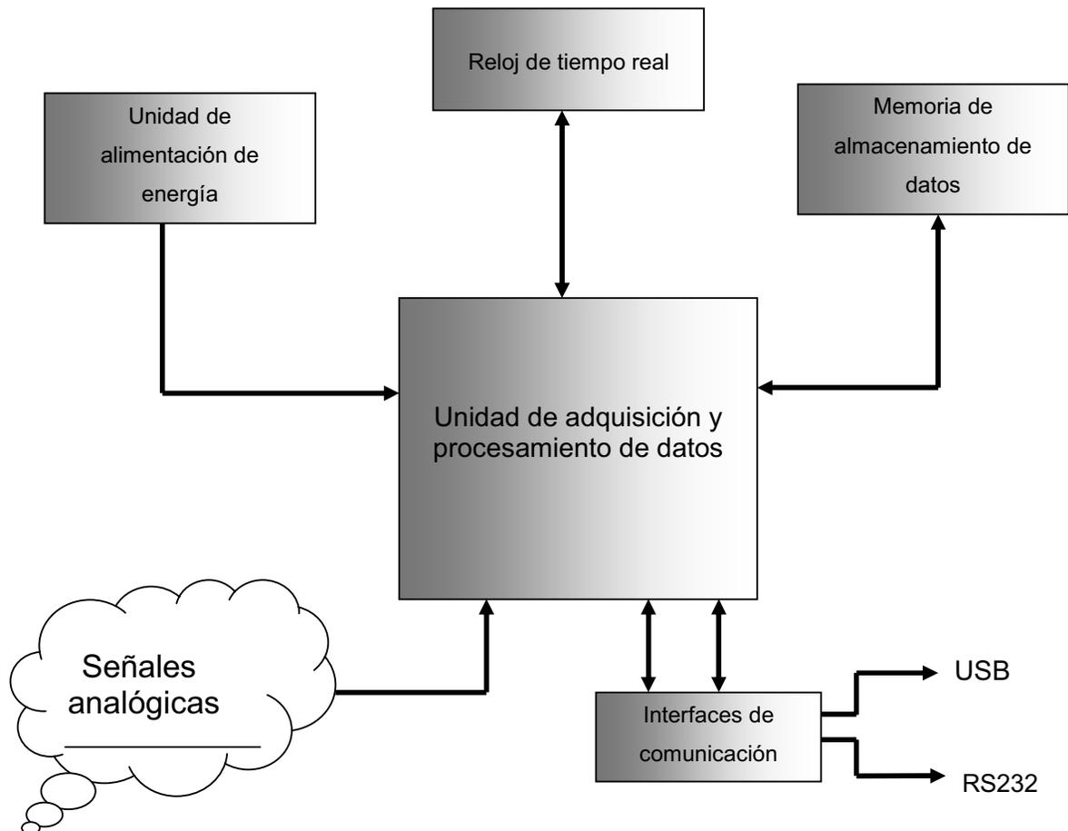
Figura 3.1. Diagrama de bloques de la estación remota.
