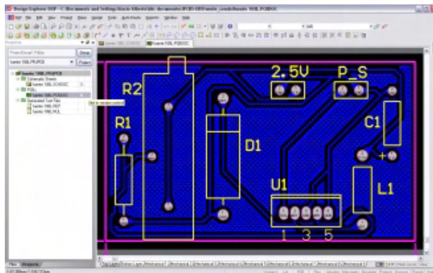
Figura 5.16. Circuito impreso de la fuente de 2.56 V generado.
