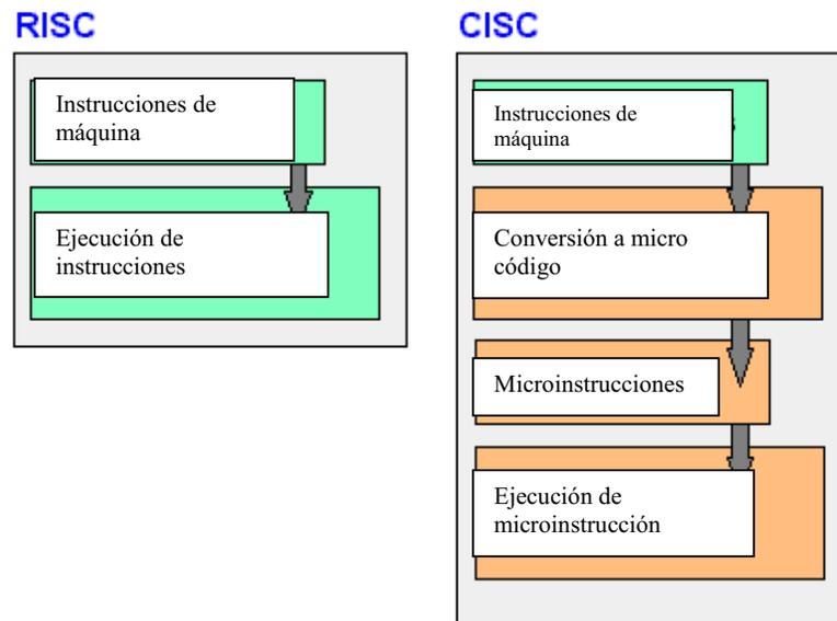
Figura 2.4. Comparativa entre un microcontrolador RISC y un CISC.
