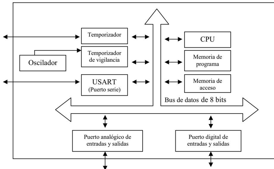
Figura 2.7. Microcontrolador de 8 bits.
