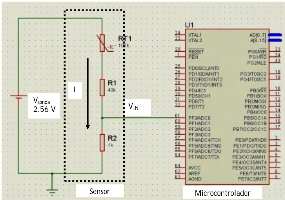
Figura 4.5. Conexión física entre la sonda y el microcontrolador.
