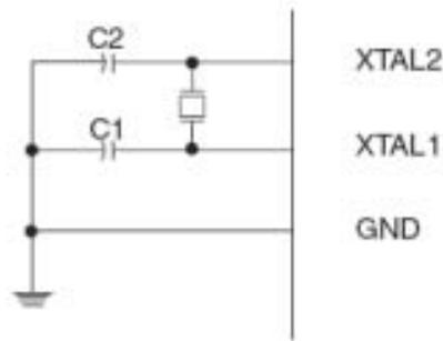
Figura 3.10. Montaje de una fuente de reloj externo al microcontrolador AVR.
