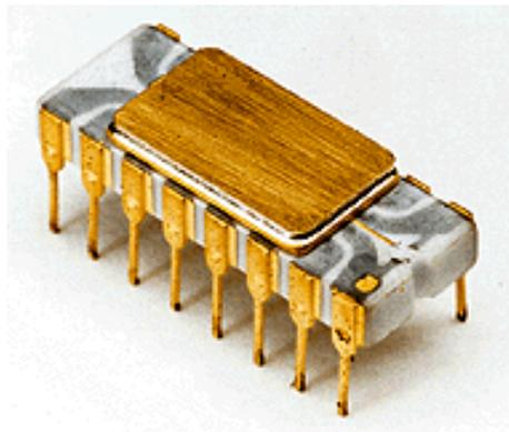
*Figura 2.1. Microprocesador Intel 4004.*
