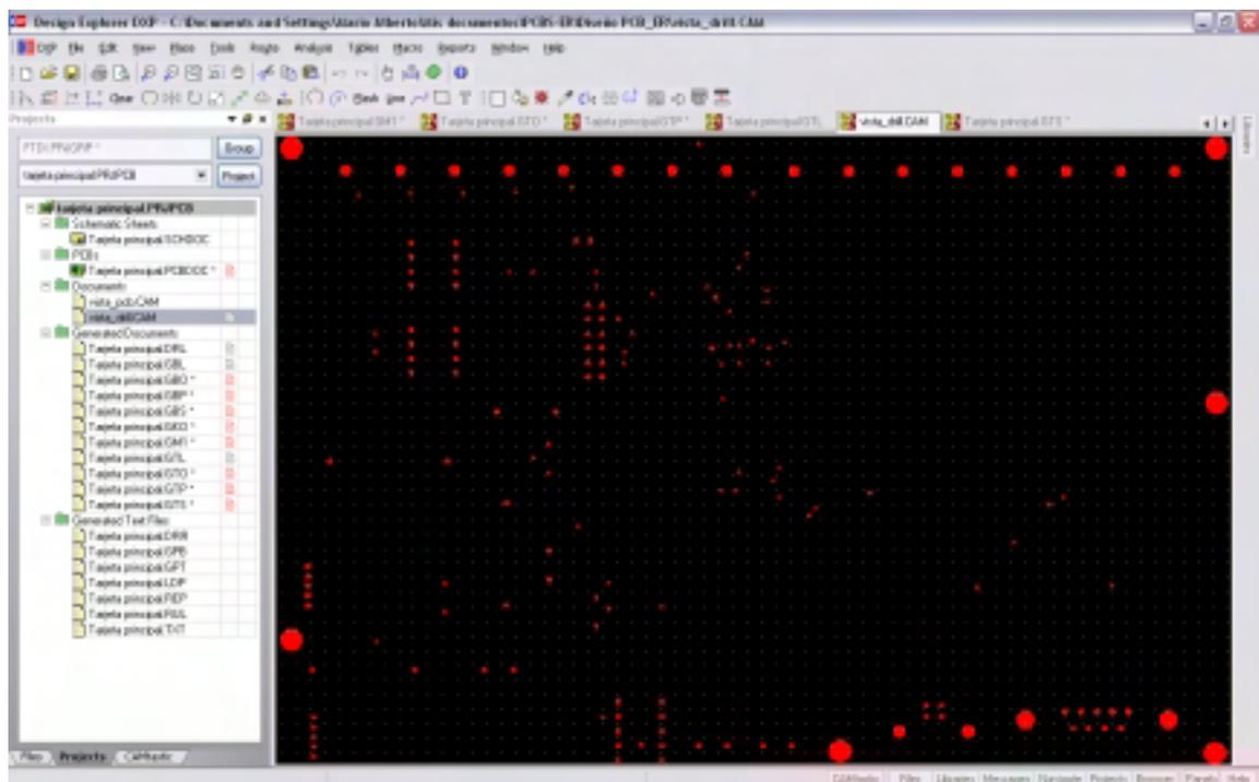
Figura 5.9. Disposición de perforaciones de la PCB.
