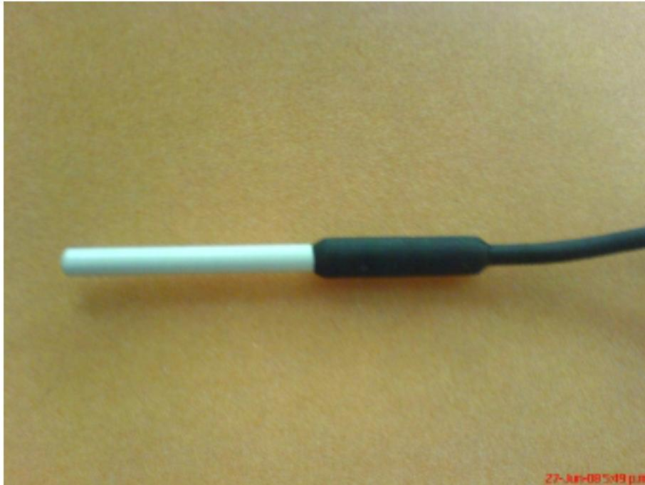
*Figura 3.38. Sonda de temperatura.*
