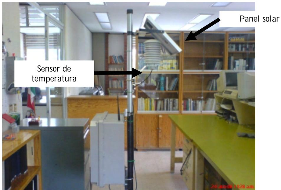
*Figura 5.21. Instalación del panel solar y del sensor de temperatura en la estructura de la ER.*
