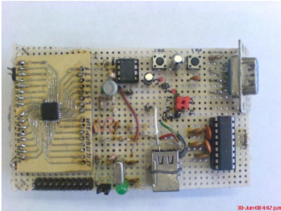
*Figura 3.37. Convertidor USB a RS232.*
