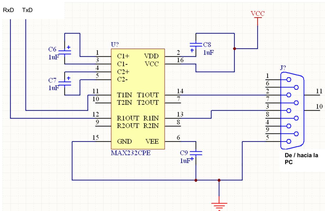
Figura 3.14. Configuración típica para el transceptor MAX232 y un microcontrolador.
