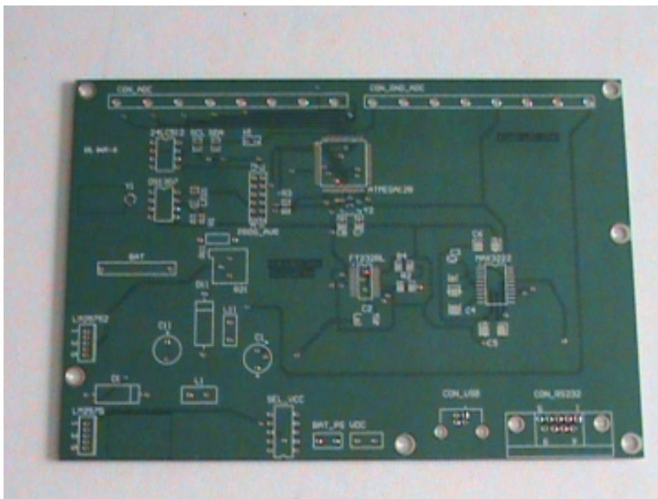
Figura 5.12. Circuito impreso de la estación remota versión 1.0 (vista superior).
