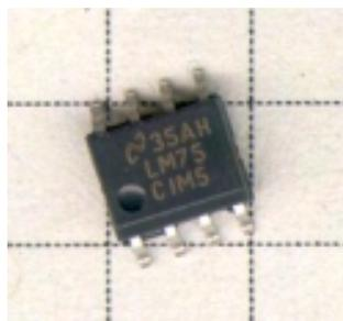
*Figura 2.14. Sensor de temperatura LM75.*
