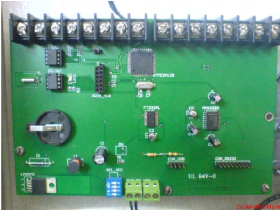
Figura 5.14. PCB versión 0.0 con componentes montados.
