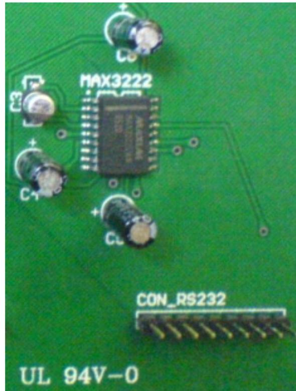
*Figura 3.32. Circuito integrado para el protocolo RS232.*
