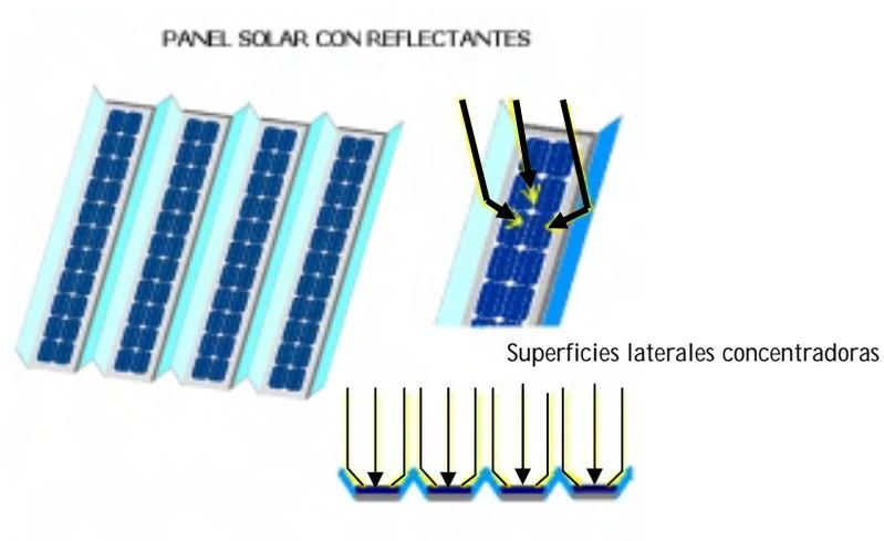
Figura 2.18. Paneles con sistemas de concentración.
