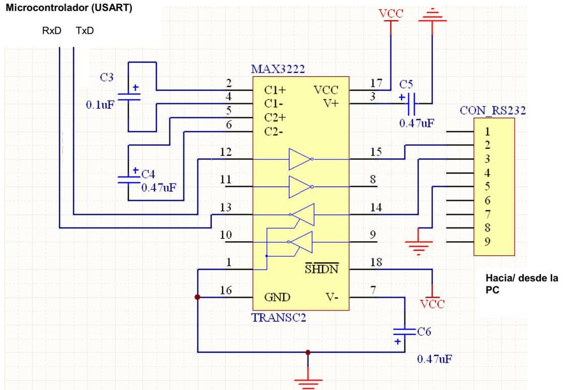
Figura 3.15. Transceptor MAX3222 y un microcontrolador.
