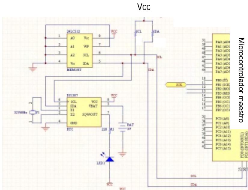
Figura 3.26. Conexión entre el microcontrolador maestro y los circuitos DS1307 y 24LC512.
