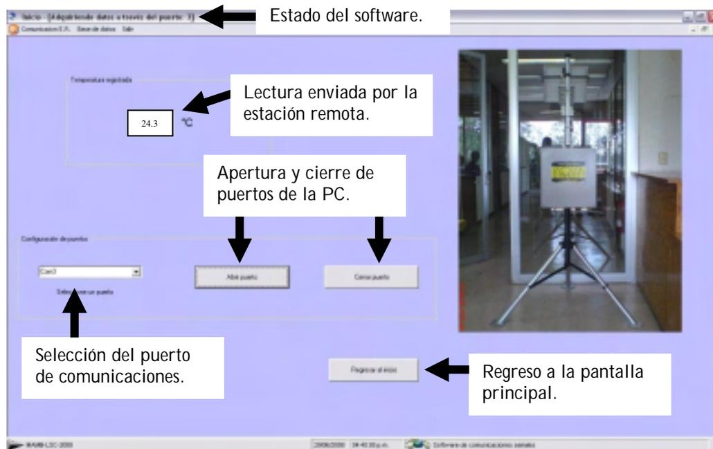
Figura 4.14. Módulo para comunicaciones seriales.
