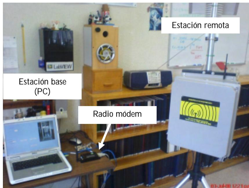
*Figura 5.22. Pruebas de enlace entre la EB y ER.*
