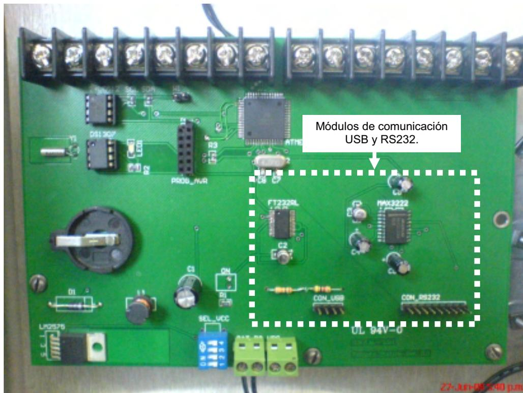
*Figura 3.31. Protocolos de comunicación RS232 y USB.*
