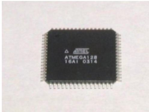
*Figura 3.3. Microcontrolador ATMEGA128.*
