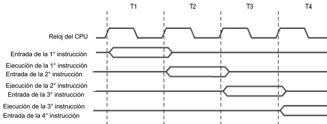
Figura 3.5. Dinámica de carga y ejecución de instrucciones para AVR.
