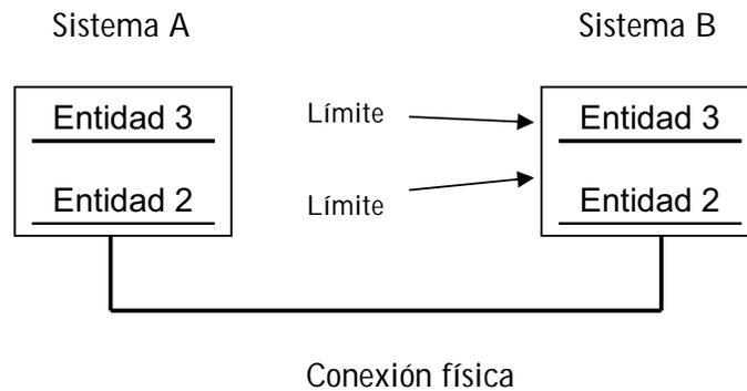
Figura 1.8. Un modelo de comunicaciones estratificado.
