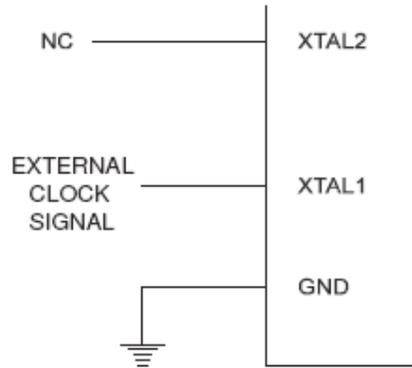
Figura 3.12. Configuración para una fuente de reloj externo.
