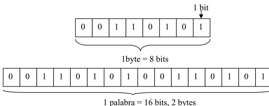
Figura 1.11. Ejemplo de bit, byte y palabra.
