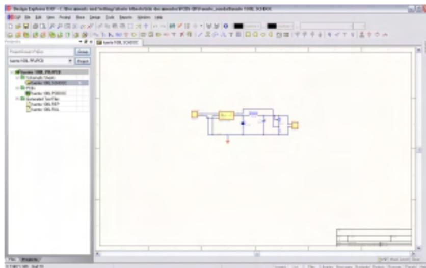
Figura 5.15. Captura del circuito esquemático para la fuente de 2.56V.
