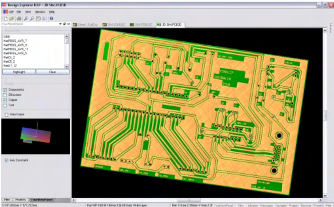
Figura 5.3. Vista 3D de una tarjeta PCB, creada con software especializado.
