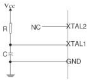
Figura 3.11. Configuración de una red RC externa.
