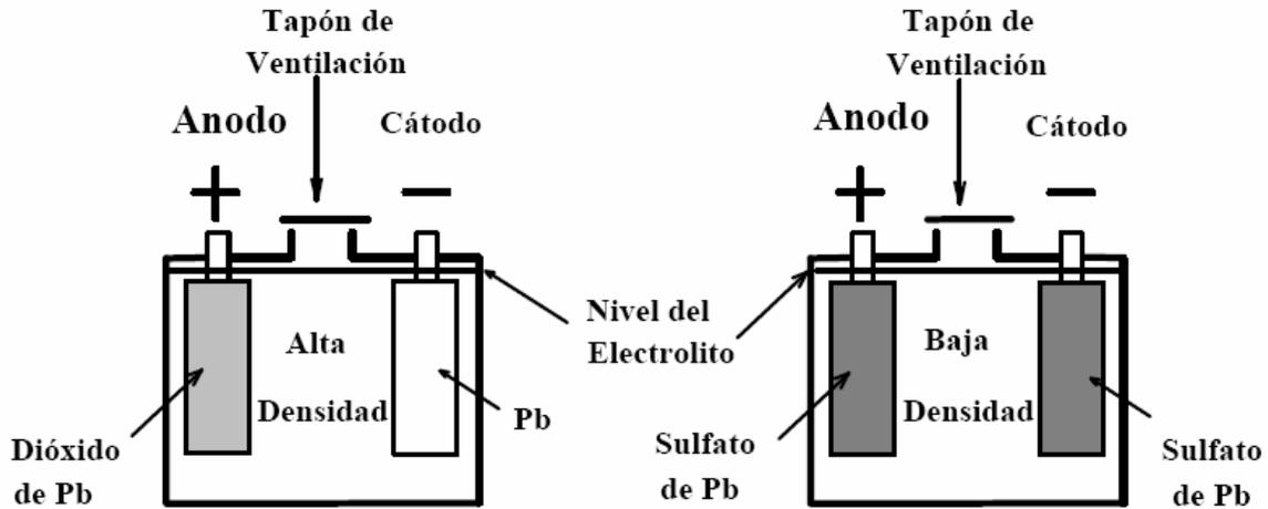
Figura 2.21. Batería cargada.
